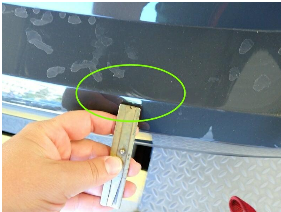
Bild 13 : Ladekante Kofferraum Kratzer/Druckstelle
