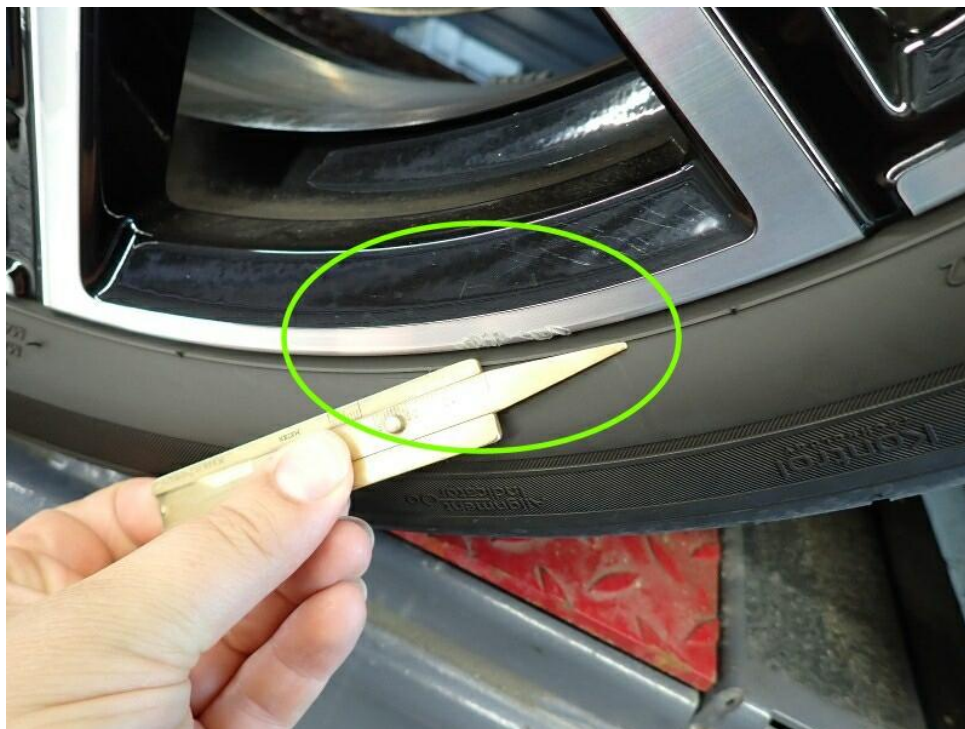
Bild 15 : Felge VR verschrammt (glanzgedreht)
