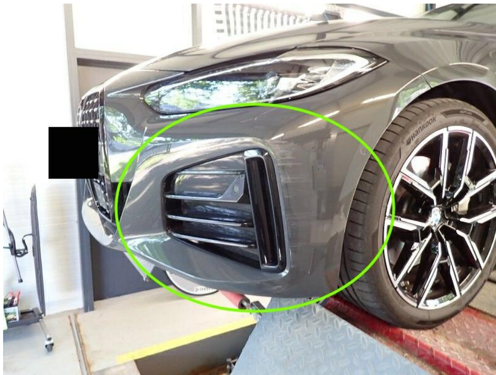
Bild 17 : Streifschaden VL (Stoßfänger vorn verschrammt mit Materialabtrag und Blende VL verschrammt)
