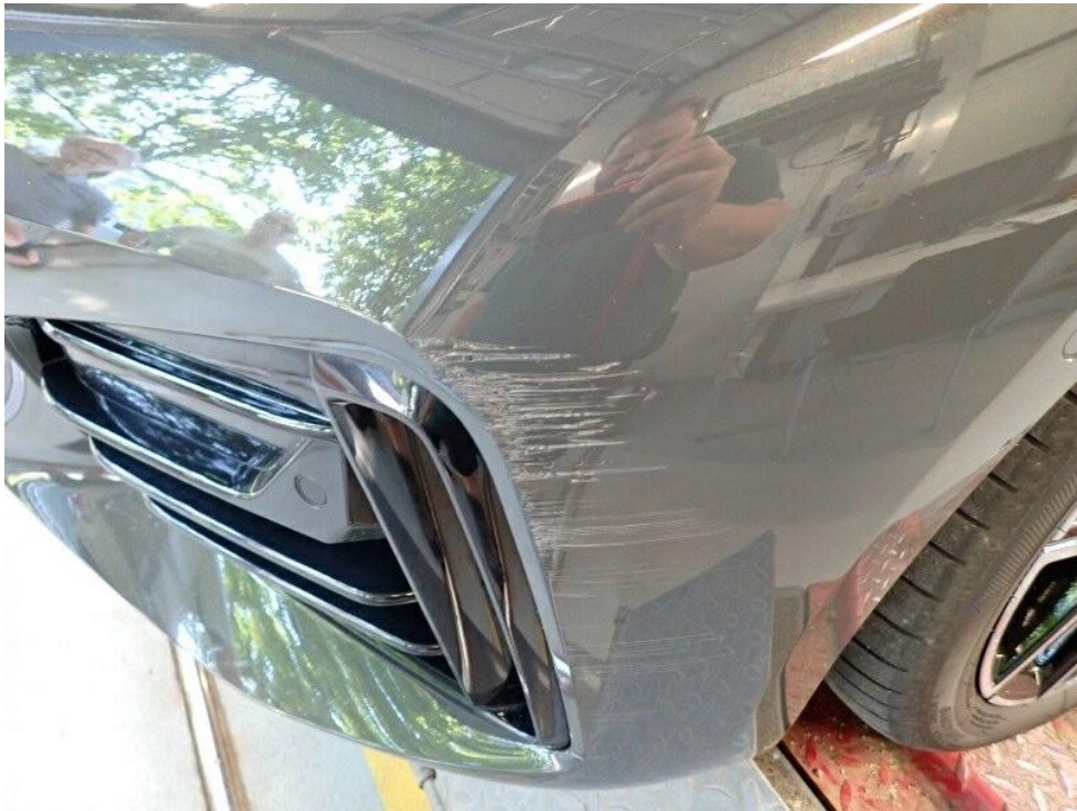
Bild 21 : Streifschaden VL (Stoßfänger vorn verschrammt mit Materialabtrag und Blende VL verschrammt)
