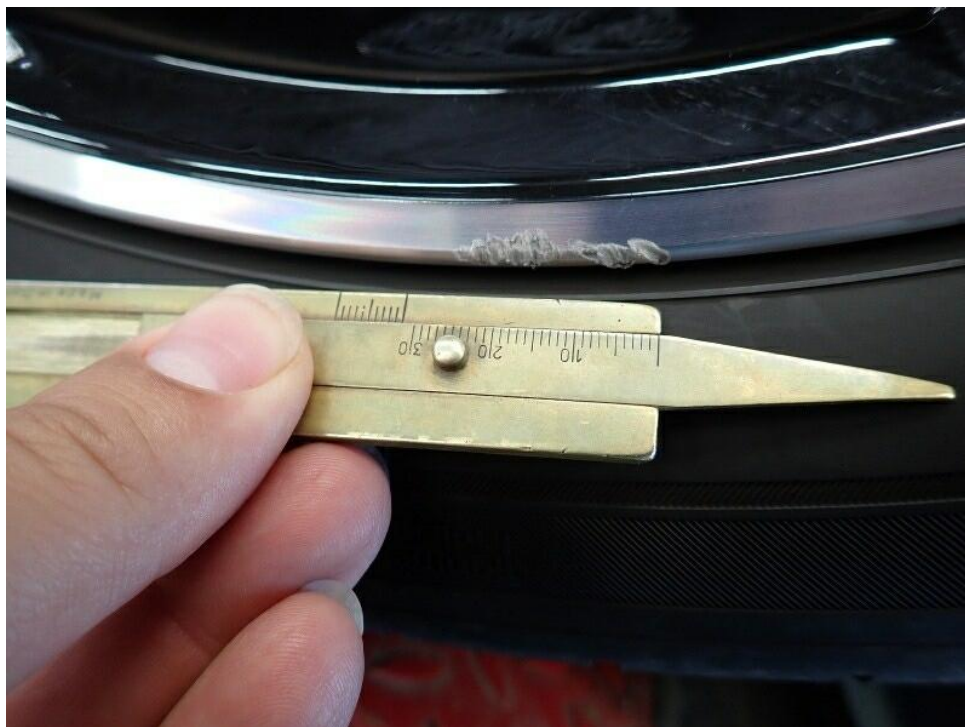
Bild 16 : Felge VR verschrammt (glanzgedreht)
