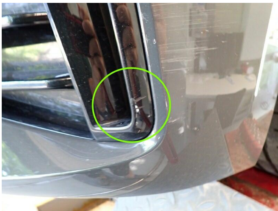
Bild 18 : Streifschaden VL (Stoßfänger vorn verschrammt mit Materialabtrag und Blende VL verschrammt)
