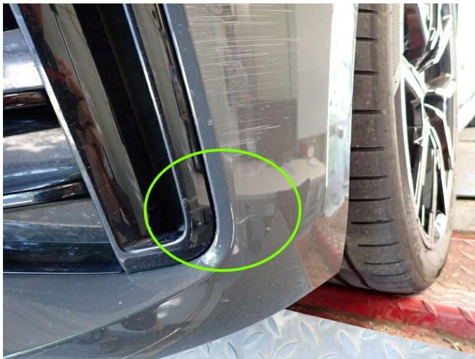
Bild 19 : Streifschaden VL (Stoßfänger vorn verschrammt mit Materialabtrag und Blende VL verschrammt)
