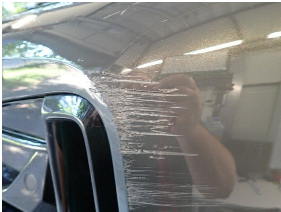
Bild 20 : Streifschaden VL (Stoßfänger vorn verschrammt mit Materialabtrag und Blende VL verschrammt)
