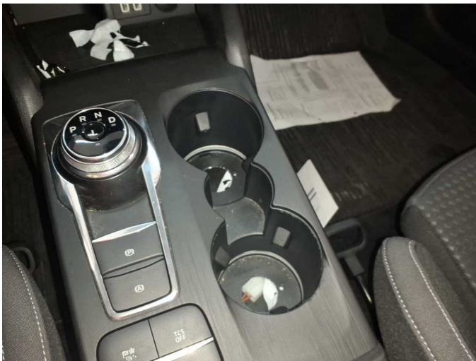
Damage 12: Instrument panel: Centre console - front (Getränkehalter, Fehlbohrungen) - Differs from the original configuration - Replace
