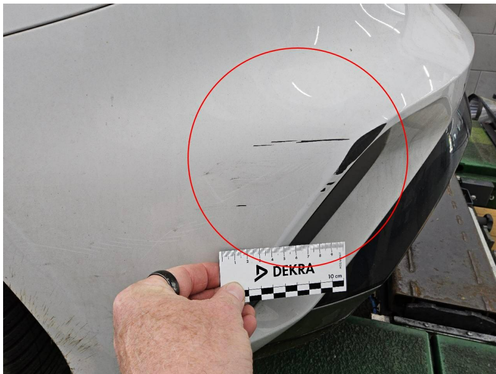
Bild 19 : Stoßfänger hinten verschrammt mit Materiealabtrag
