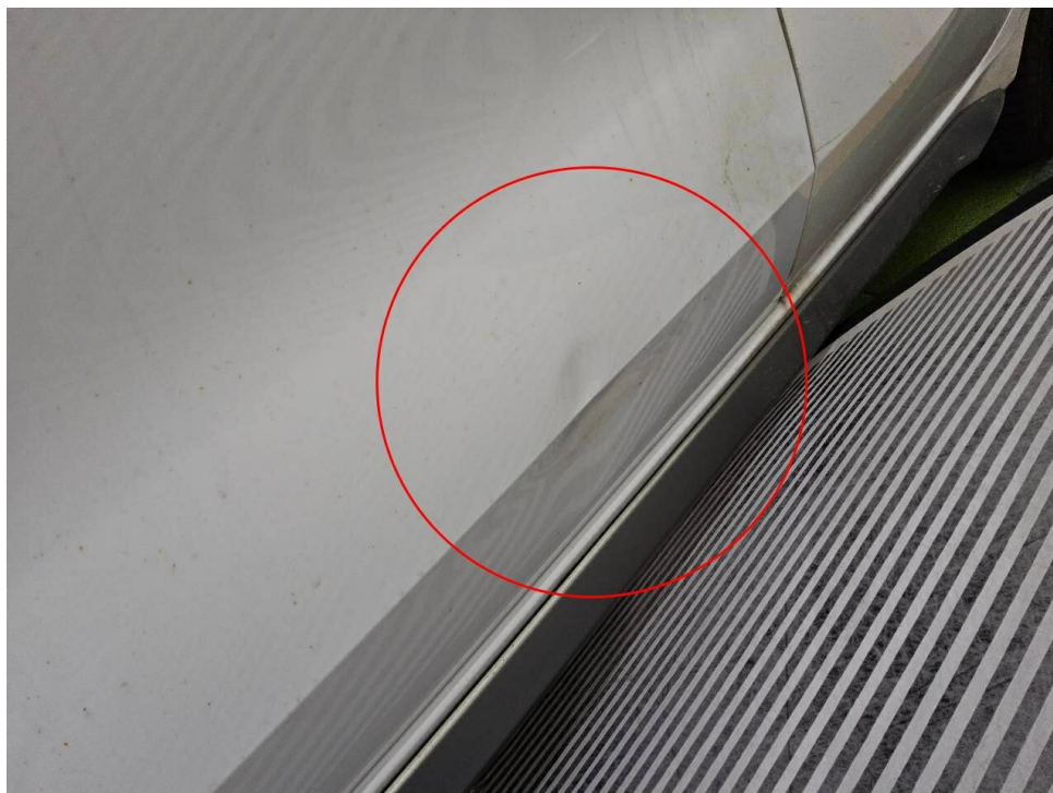
Bild 18 : Tür vorne deformiert
