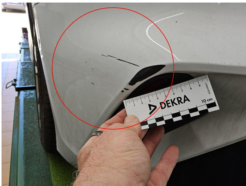
Bild 20 : Stoßfänger hinten verschrammt mit Materiealabtrag
