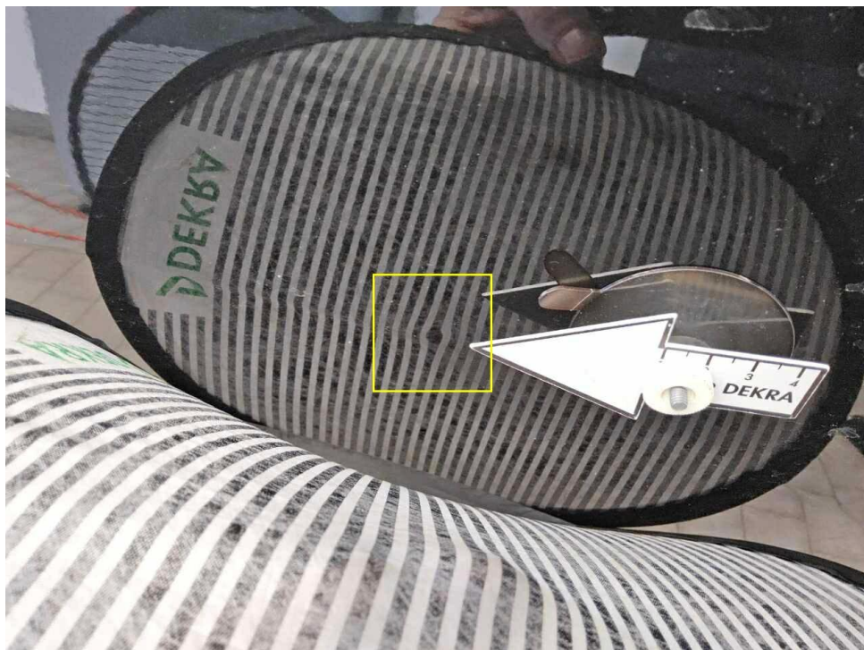
Bild 12 : Seitenteil hinten rechts, eingedellt, drücken
