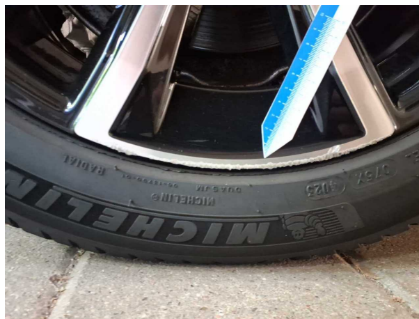
Beschädigung #5: Rad/Reifen: Leichtmetallfelge hinten rechts - verkratzt / verschürft - erneuern
