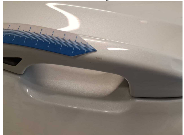
Beschädigung #4: Tür hinten links: Griff außen - Kratzer - Smart Repair
