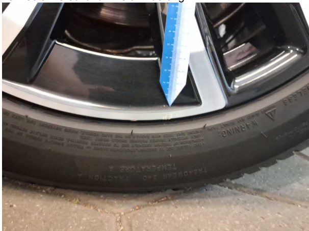
Beschädigung #2: Rad/Reifen: Leichtmetallfelge hinten links - verkratzt / verschürft - Wertminderung
