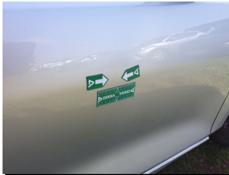
Porte / Avant Droit / Enfoncement
