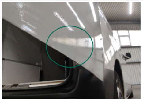
Heckklappe / Kofferraumtür / Unten Rechts / Schlecht Repariert
