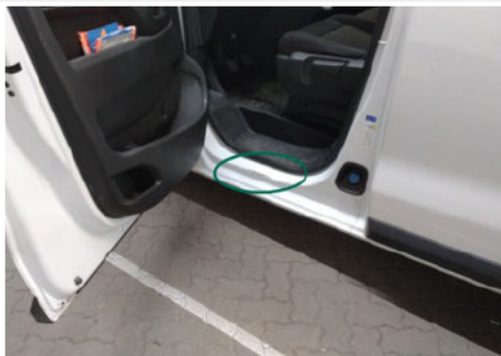
Türeinstieg / Vorne Links / Abgewetzt
