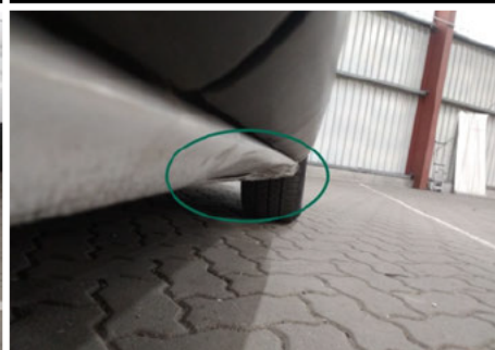
Schweller / Vorne Rechts / Delle
