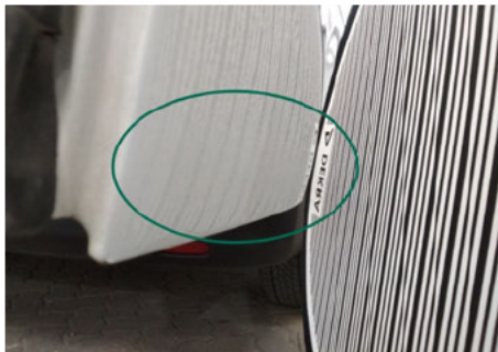
Heckklappe / Kofferraumtür / Unten Rechts / Schlecht Repariert
