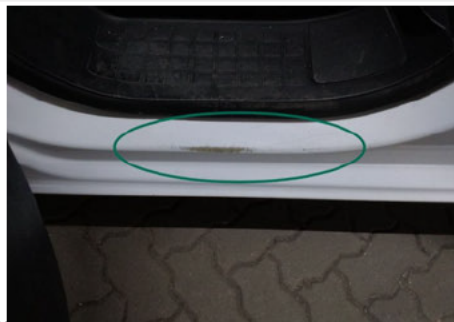
Türeinstieg / Vorne Links / Abgewetzt
