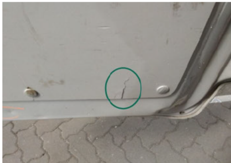
Innenverkleidung Laderaum / Unten Hinten Links / Gebrochen
