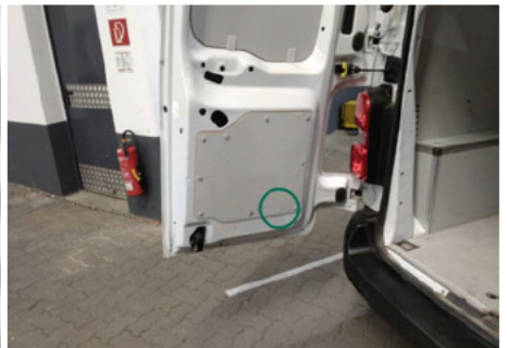
Innenverkleidung Laderaum / Unten Hinten Links / Gebrochen
