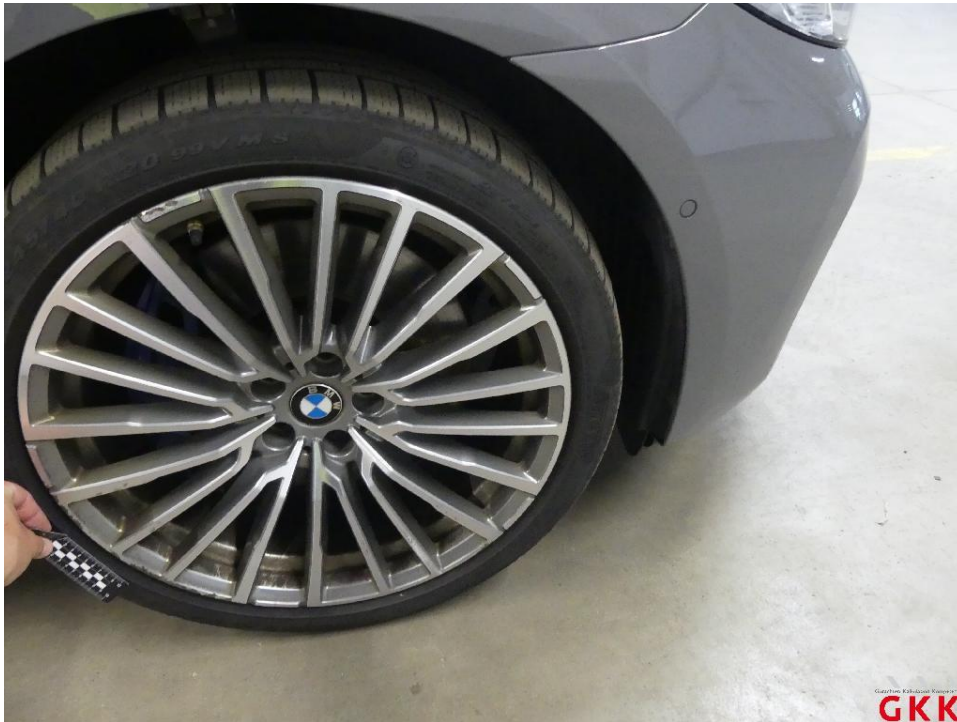
Bild 21 LM-Rad, vorne rechts, verkratzt, Smartrepair
