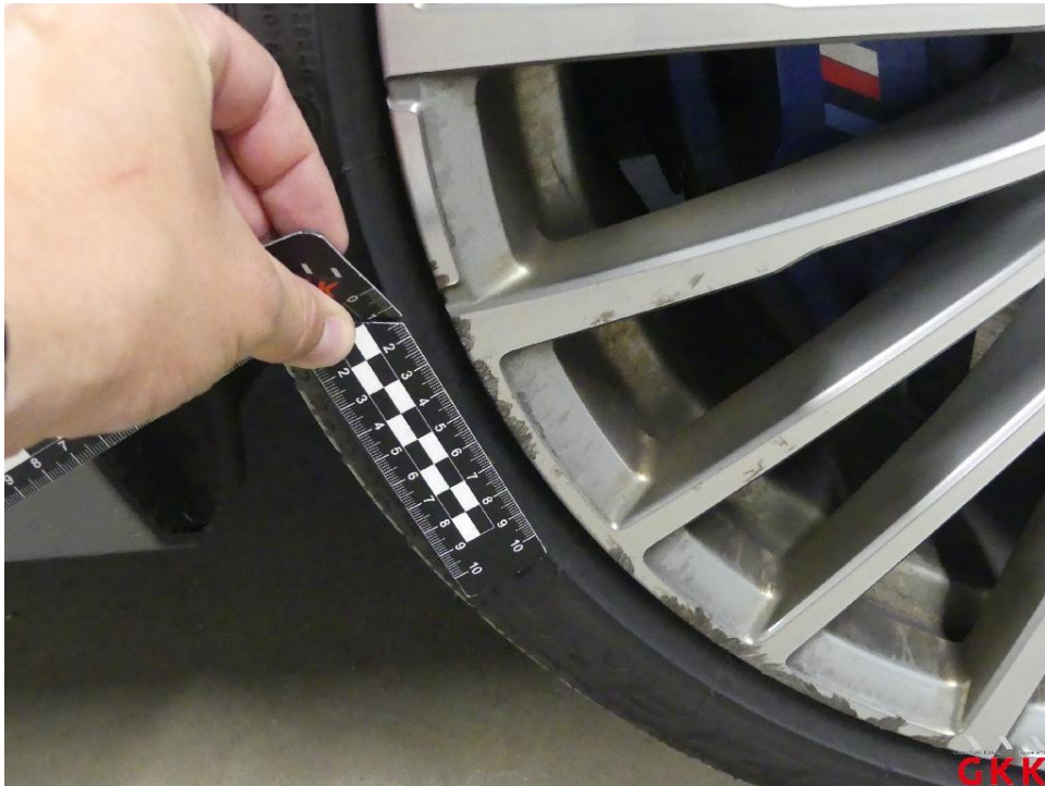
Bild 23 LM-Rad, vorne rechts, verkratzt, Smartrepair
