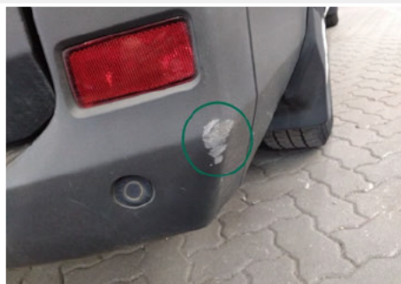
Stoßfänger / Hinten / Gebrochen
