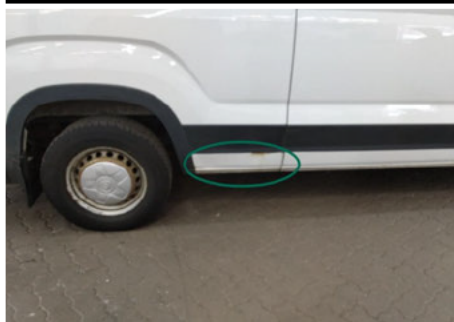
Schweller / Hinten Rechts / Delle
