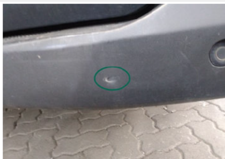
Stoßfänger / Hinten / Gebrochen
