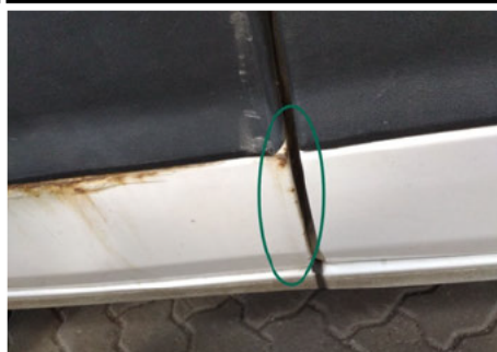
Schweller / Hinten Rechts / Delle
