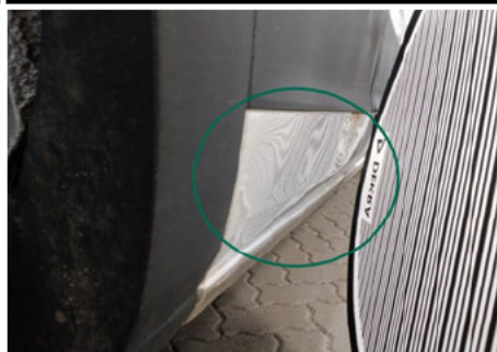
Schweller / Hinten Rechts / Delle
