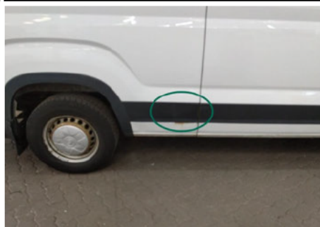
Zierleiste Seitenwand / Hinten Rechts / Kratzer
