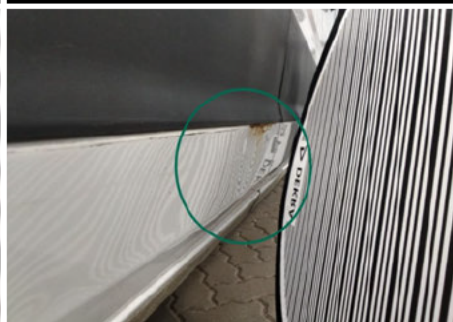
Schweller / Hinten Rechts / Delle
