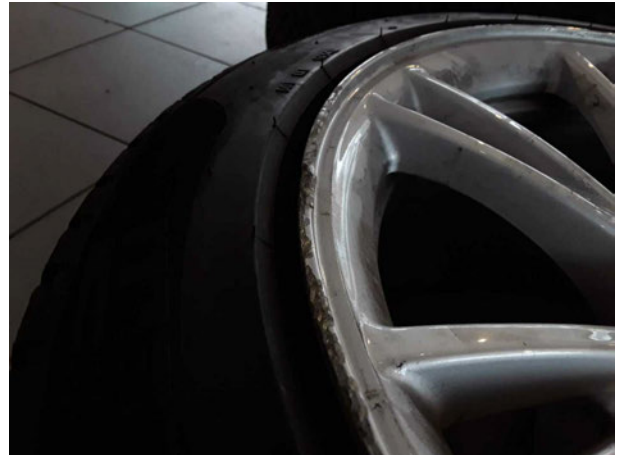
Beschädigung #4: 2.Radsatz: 2 Leichtmetallfelgen (Winter, Materialabtrag) - beschädigt - erneuern
