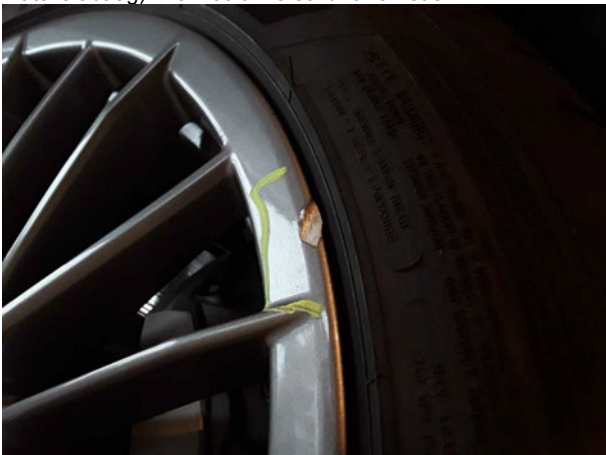
Beschädigung #2: Rad/Reifen: Leichtmetallfelge vorn links (Sommer, Materialabtrag) - verkratzt / verschürft - erneuern
