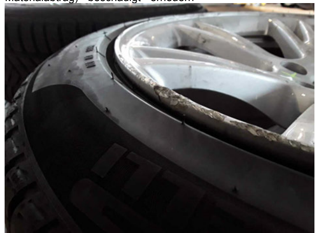
Beschädigung #4: 2.Radsatz: 2 Leichtmetallfelgen (Winter, Materialabtrag) - beschädigt - erneuern
