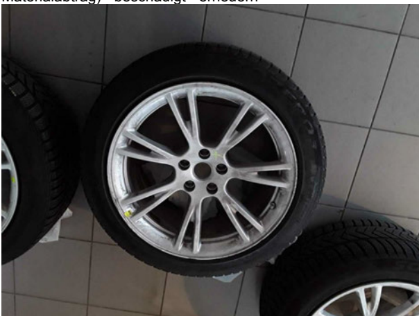
Beschädigung #4: 2.Radsatz: 2 Leichtmetallfelgen (Winter, Materialabtrag) - beschädigt - erneuern
