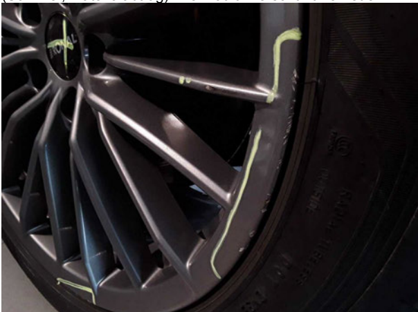
Beschädigung #1: Rad/Reifen: Leichtmetallfelge hinten rechts (Sommer, Materialabtrag) - verkratzt / verschürft - erneuern
