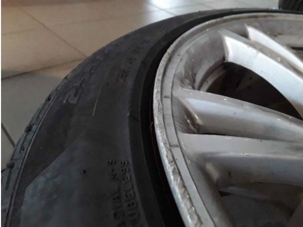
Beschädigung #4: 2.Radsatz: 2 Leichtmetallfelgen (Winter, Materialabtrag) - beschädigt - erneuern
