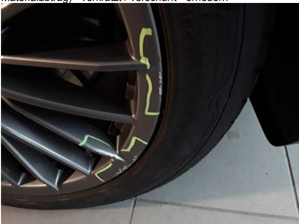
Beschädigung #3: Rad/Reifen: Leichtmetallfelge vorn rechts (Sommer, Materialabtrag) - verkratzt / verschürft - erneuern
