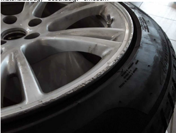
Beschädigung #4: 2.Radsatz: 2 Leichtmetallfelgen (Winter, Materialabtrag) - beschädigt - erneuern
