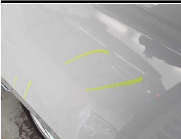
Beschädigung #11: Seitenwand links: Seitenwand - Delle / Lackschaden - instandsetzen und lackieren
