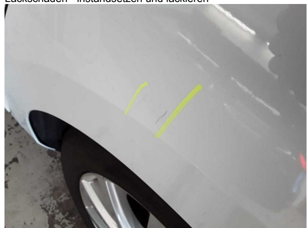
Beschädigung #11: Seitenwand links: Seitenwand - Delle / Lackschaden - instandsetzen und lackieren
