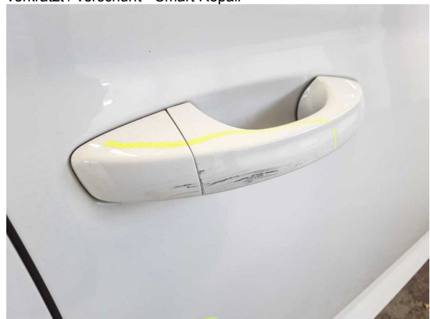
Beschädigung #9: Tür vorn rechts: Griff außen - verkratzt / verschürft - instandsetzen und lackieren
