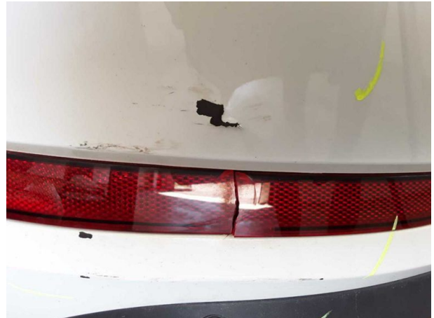
Beschädigung #2: Verkleidungen/Abdeckungen: Verkleidungen/Abdeckungen (Reflektor li.) - erneuern
