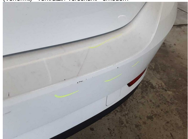
Beschädigung #12: Stossfänger hinten: Stossfänger hinten (Verformt) - verkratzt / verschürft - erneuern
