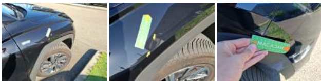
Wing trim FR, Scratch(es), Replace
