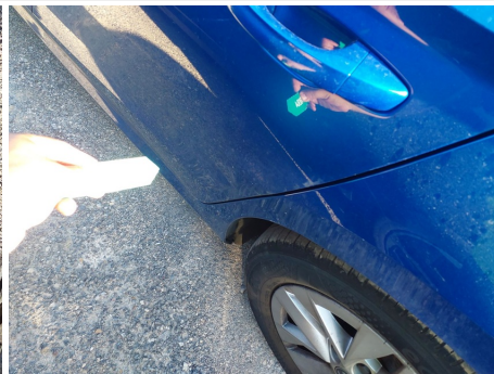
Puerta / Trasero Izquierdo / Abolladura
