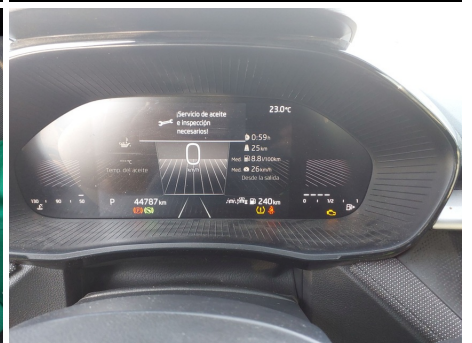
Indicador de mantenimiento / Faltante
