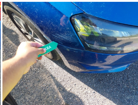
Aleta / Delantero Derecho / Abolladura
