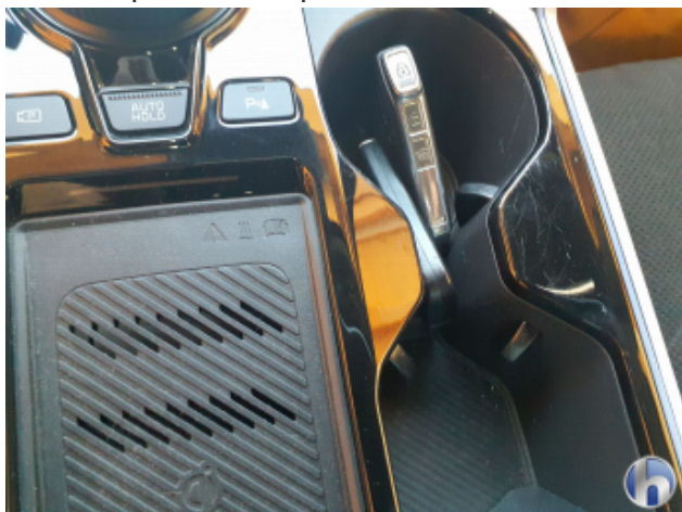
5. Mittelkonsole Innenraum vorne mitte Kratzer - Erneuern
