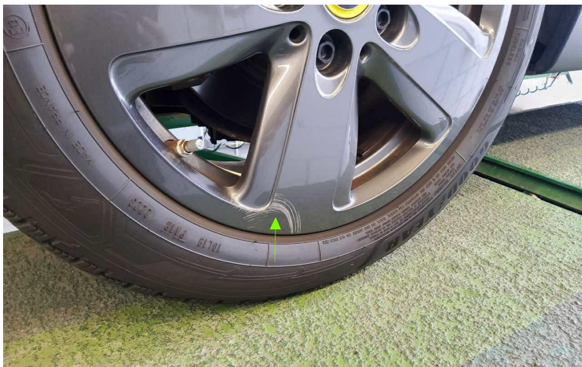
Bild 16 : Alufelge hinten rechts verschrammt
