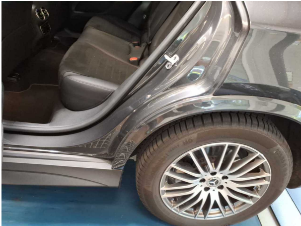
Beschädigung #1: Seitenwand links: Einstieg - Kratzer - Smart Repair
