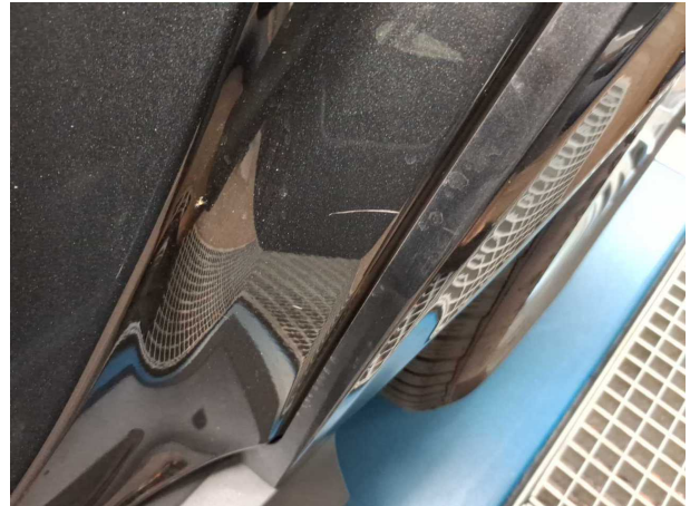
Beschädigung #1: Seitenwand links: Einstieg - Kratzer - Sm... Repair
