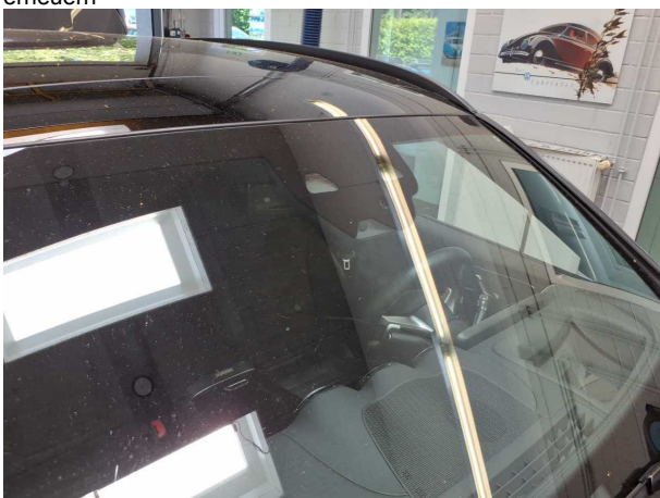
Beschädigung #4: Verglasung: Frontscheibe - Steinschlag - erneuern
