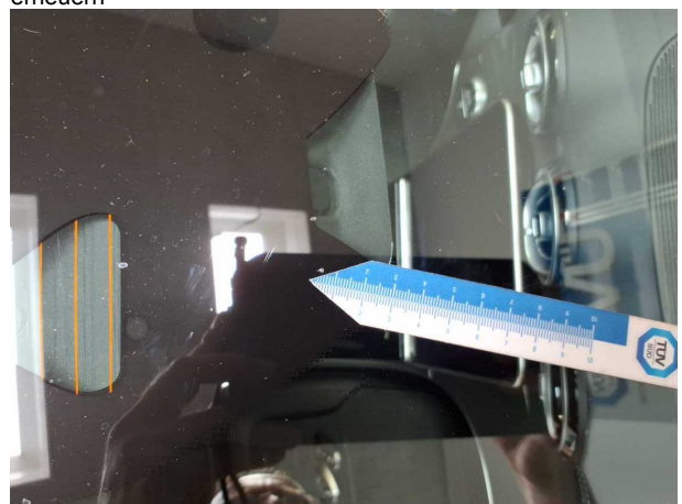
Beschädigung #4: Verglasung: Frontscheibe - Steinschlag - erneuern
