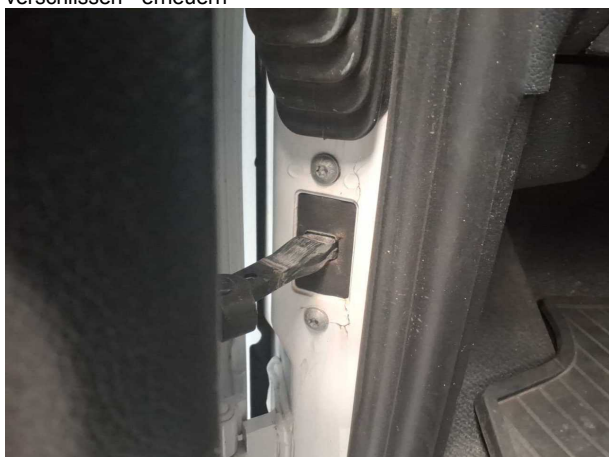
Beschädigung #16: Karosserie: A-Säule links - gebrochen / gerissen - instandsetzen/lackieren (S2)
