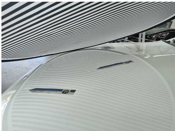
Beschädigung #7: Motorhaube: Motorhaube - Delle(n) - Smart Repair
