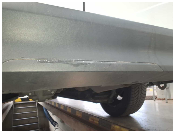
Beschädigung #3: Verkleidungen/Abdeckungen: Verkleidungen/ Abdeckungen (Abdeckung AHZV festgeklebt) - beschädigt -
