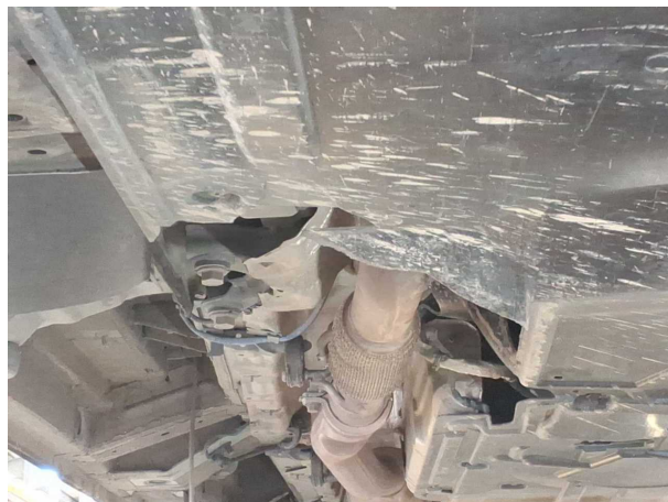
Beschädigung #8: Motor: Motorverkleidung unten - gebrochen / gerissen - erneuern
