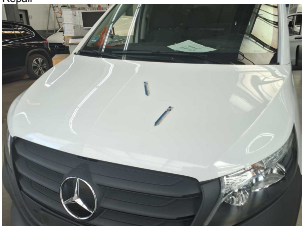
Beschädigung #7: Motorhaube: Motorhaube - Delle(n) - Smart Repair
