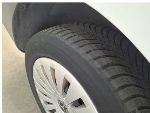
Beschädigung #11: Rad/Reifen: Reifen hinten rechts - verschlissen - erneuern
