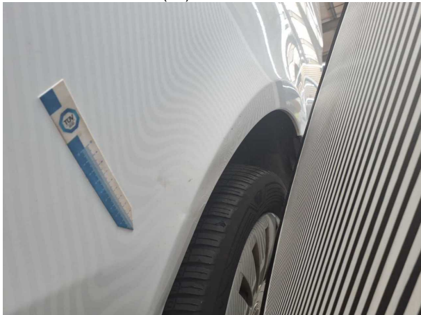
Beschädigung #19: Seitenwand links: Seitenwand - verformt - instandsetzen/lackieren (S3)
