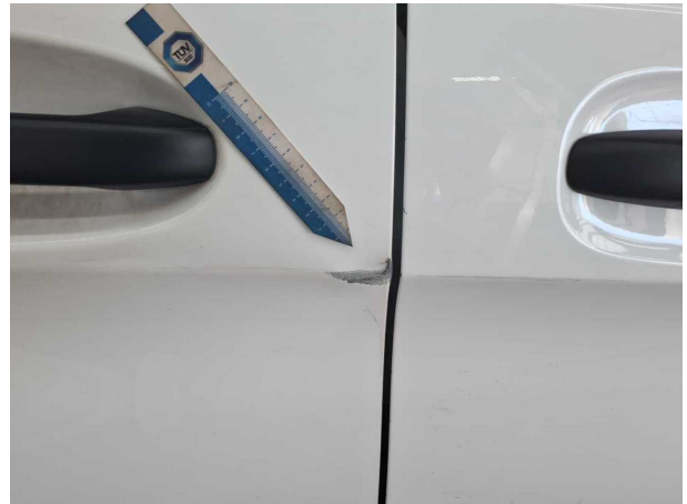
Beschädigung #18: Schiebetür rechts: Schiebetür - verformt - instandsetzen/lackieren (S2)
