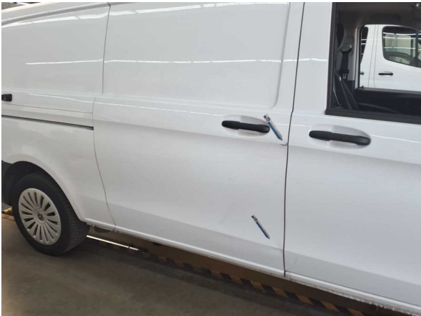
Beschädigung #18: Schiebetür rechts: Schiebetür - verformt - instandsetzen/lackieren (S2)
