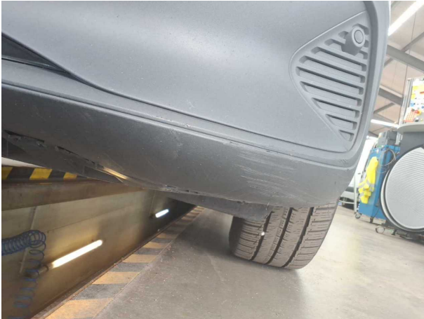
Beschädigung #17: Stossfänger vorn: Stossfänger mit Parktronic - verkratzt / verschürft - erneuern
