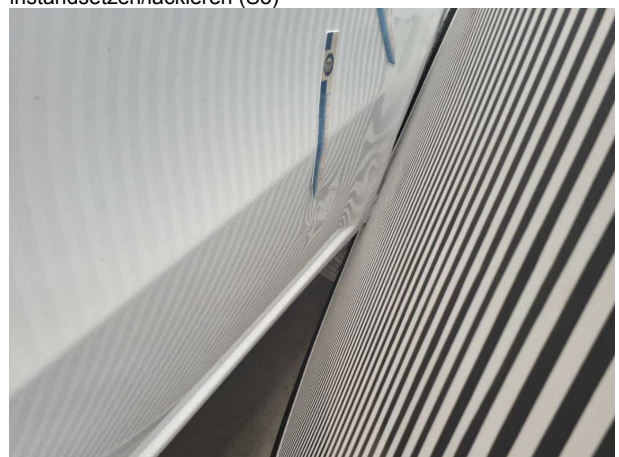
Beschädigung #19: Seitenwand links: Seitenwand - verformt - instandsetzen/lackieren (S3)
