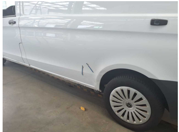
Beschädigung #19: Seitenwand links: Seitenwand - verformt - instandsetzen/lackieren (S3)
