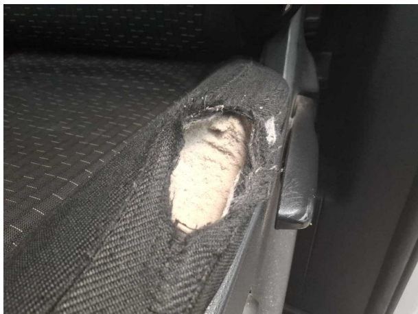
Beschädigung #12: Sitz vorn: Sitzpolster links - beschädigt - erneuern
