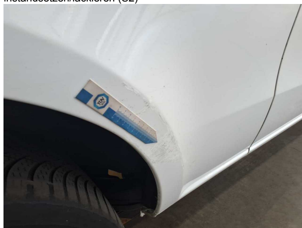
Beschädigung #20: Seitenwand rechts: Seitenwand - verformt - instandsetzen/lackieren (S2)
