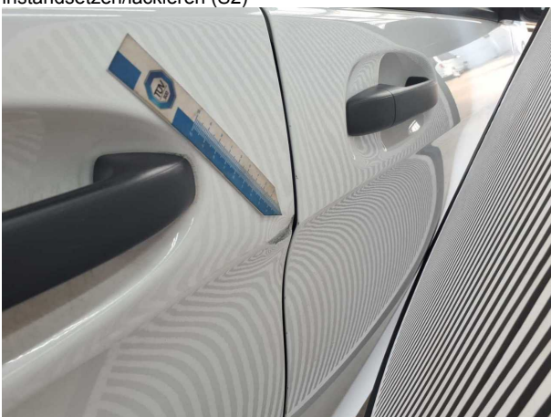
Beschädigung #18: Schiebetür rechts: Schiebetür - verformt - instandsetzen/lackieren (S2)
