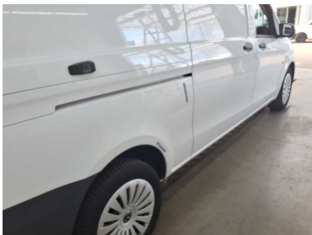
Beschädigung #20: Seitenwand rechts: Seitenwand - verformt - instandsetzen/lackieren (S2)
