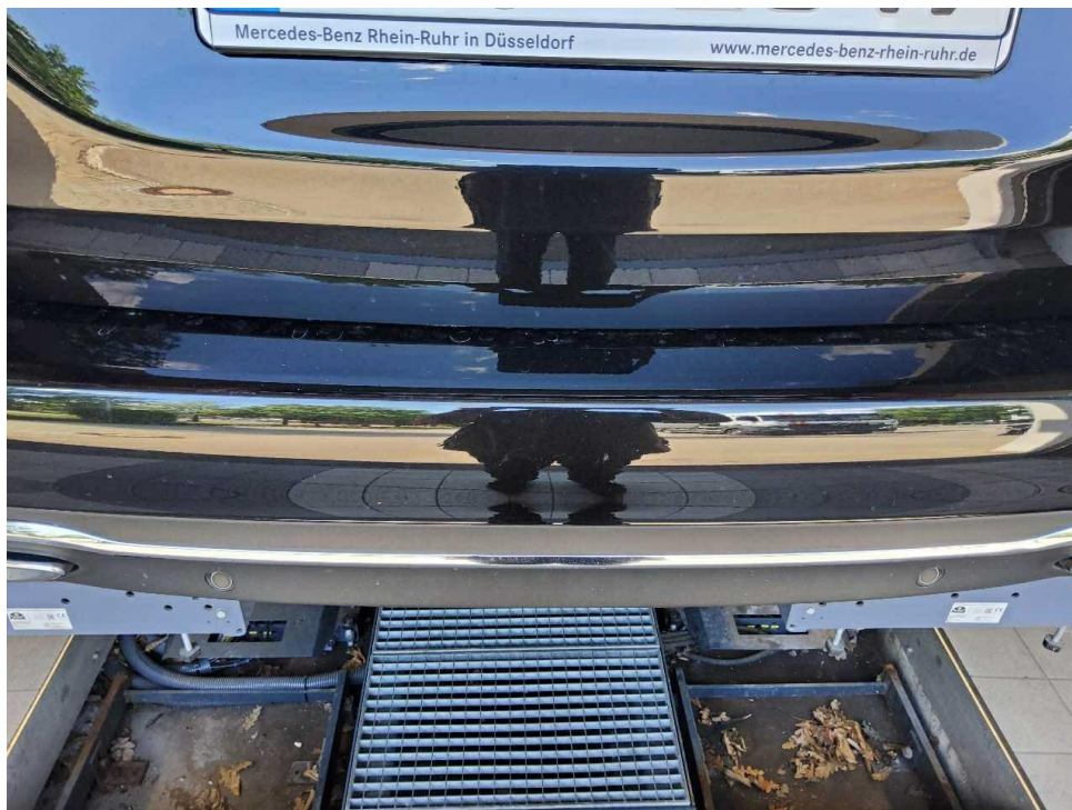
Bild 25 : Stoßfänger hinten Lackierung, zerkratzt, Gebrauchsspur
