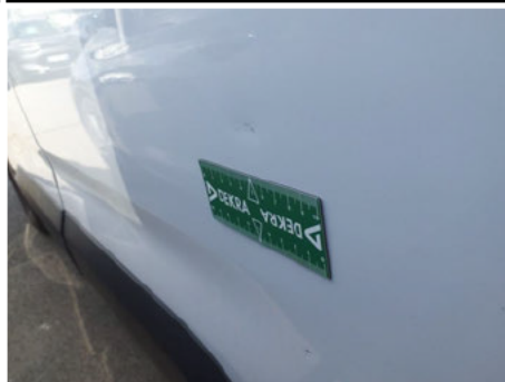
Aile / Arrière Gauche / Enfoncement
