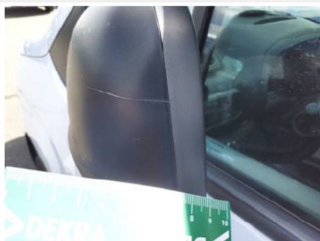
Coquille de rétroviseur / Gauche / Rayure
