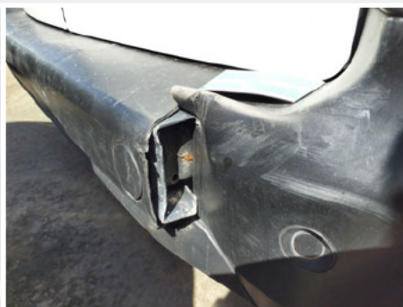
Traverse AR / Arrière / Enfoncement
