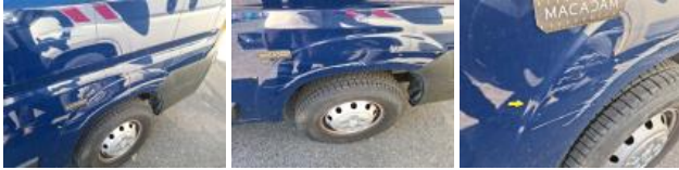
Door FL, Scratch(es), Paint
