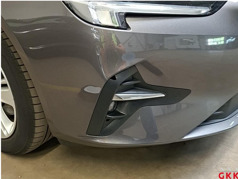
Bild 24 Stoßfänger vorne, Blende -unlackiert-, beschädigt, ersetzen
