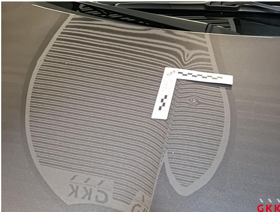
Bild 27 Motorhaube, beschädigt, instand setzen - lackieren
