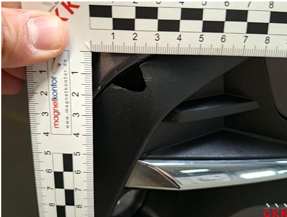
Bild 25 Stoßfänger vorne, Blende -unlackiert-, beschädigt, ersetzen
