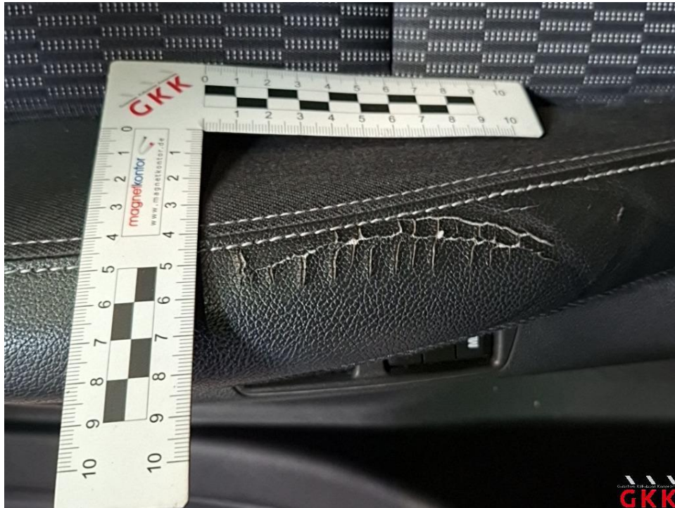
Bild 17 Sitz vorne links, Bezug Sitzkissen -Teilleder-, beschädigt, ersetzen
