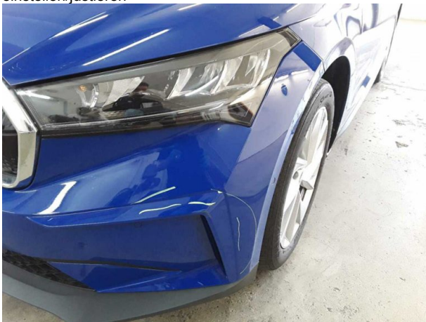
Beschädigung #8: Stossfänger vorn: Stossfänger vorn - verkratzt / verschürft - instandsetzen und lackieren
