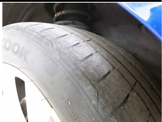
Damage #7: Wheel / tyres: Tyre - front (ausen abgefahren) - Worn - Replace
