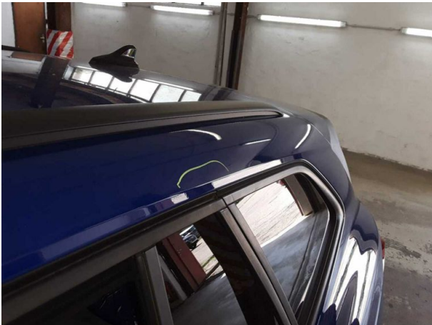
Beschädigung #3: Fahrzeugdach: Dachholm links - Delle(n) - sanft instandsetzen
