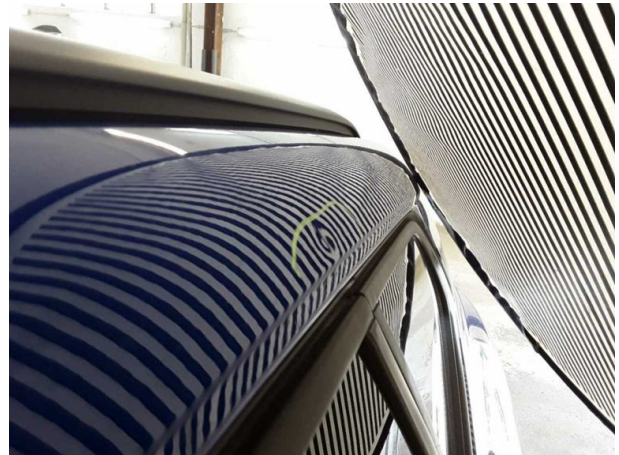
Beschädigung #3: Fahrzeugdach: Dachholm links - Delle(n) - sanft instandsetzen
