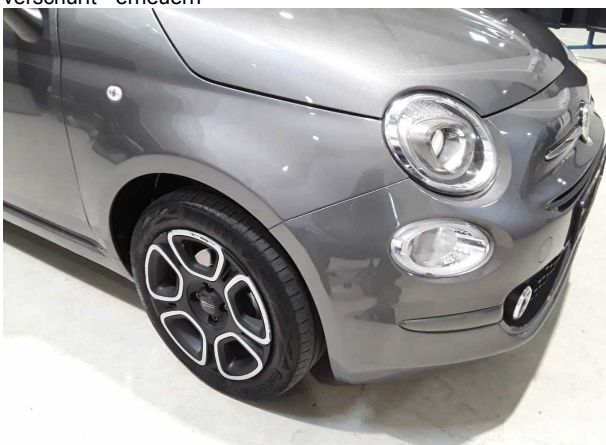
Beschädigung #7: Rad/Reifen: Radblende vorn rechts - verkratzt / verschürft - erneuern
