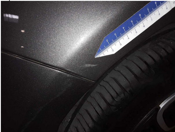
Beschädigung #4: Kotflügel links: Kotflügel links - Kratzer - Smart Repair
