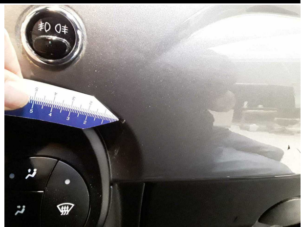
Beschädigung #12: Instrumententafel: Blende - verkratzt / verschürft - erneuern
