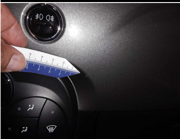
Beschädigung #12: Instrumententafel: Blende - verkratzt / verschürft - erneuern
