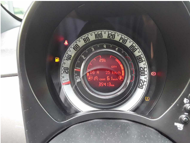
Beschädigung #2: Rad/Reifen: Drucksensor (Reifendruckkontrolle Warnhinweis im Display) - Befund festlegen - befunden ggf.
