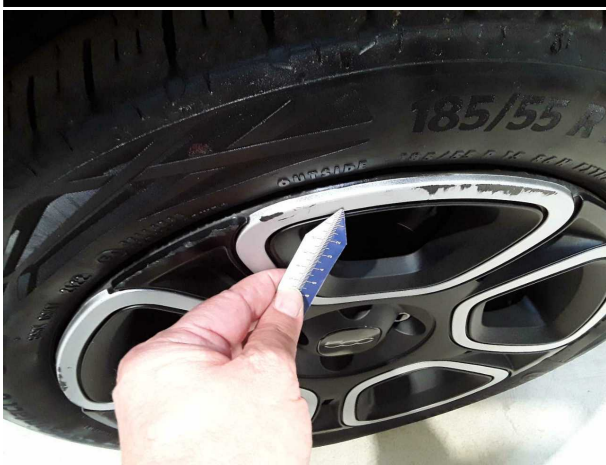
Beschädigung #7: Rad/Reifen: Radblende vorn rechts - verkratzt / verschürft - erneuern
