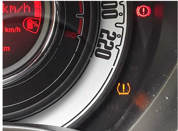
Beschädigung #2: Rad/Reifen: Drucksensor (Reifendruckkontrolle Warnhinweis im Display) - Befund
