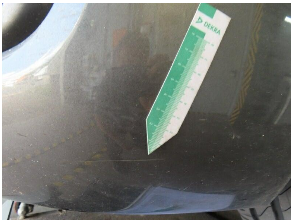
Bild 27 : Stoßfänger vorn verkratzt(Gebrauchsspur)
