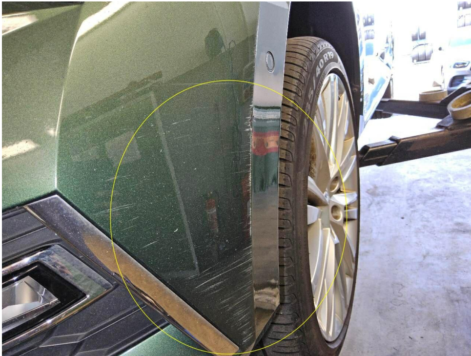
Bild 27 : Stoßfänger vorne mehrfach verschrammt mit Materialabtrag
