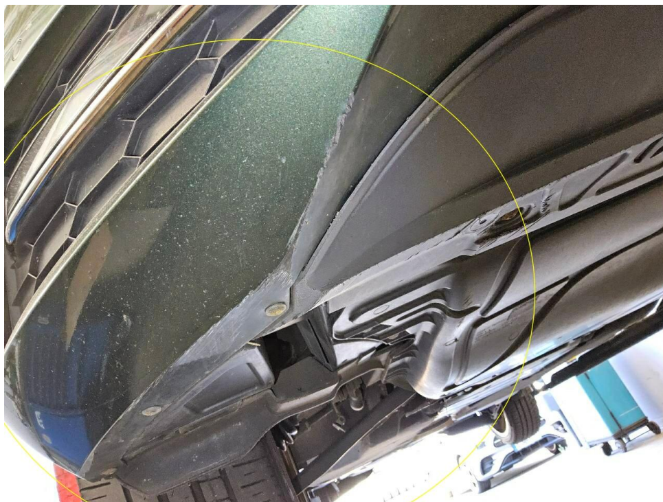
Bild 26 : Stoßfänger vorne mehrfach verschrammt mit Materialabtrag
