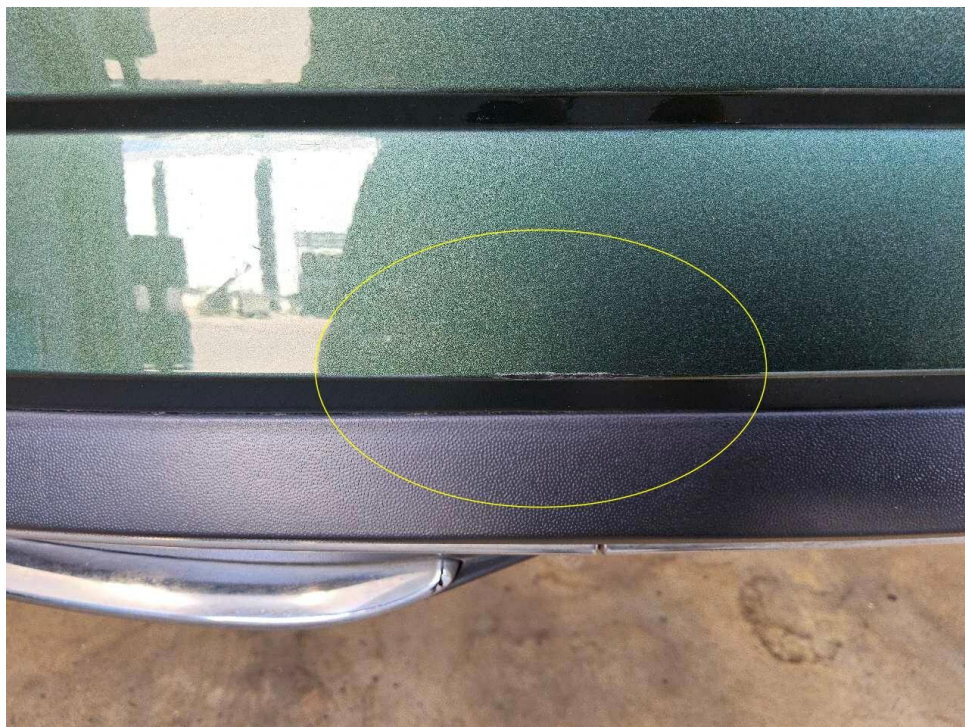
Bild 20 : Stoßfänger hinten mehrfach verkratzt
