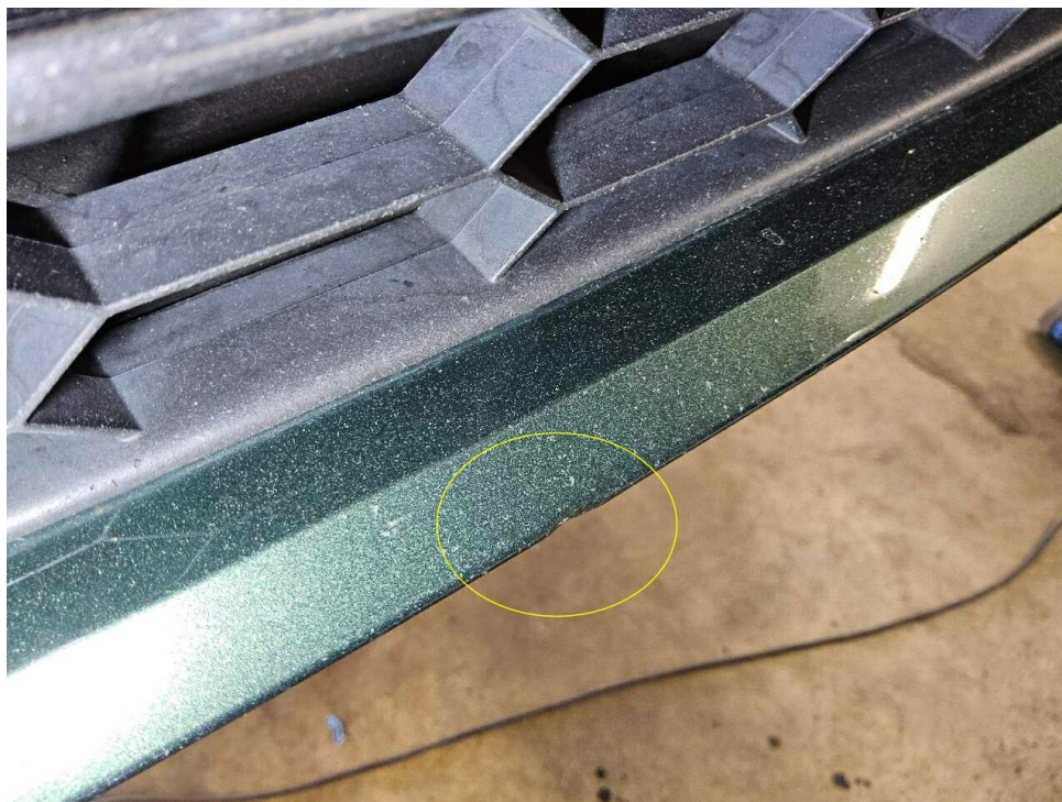
Bild 25 : Stoßfänger vorne mehrfach verschrammt mit Materialabtrag
