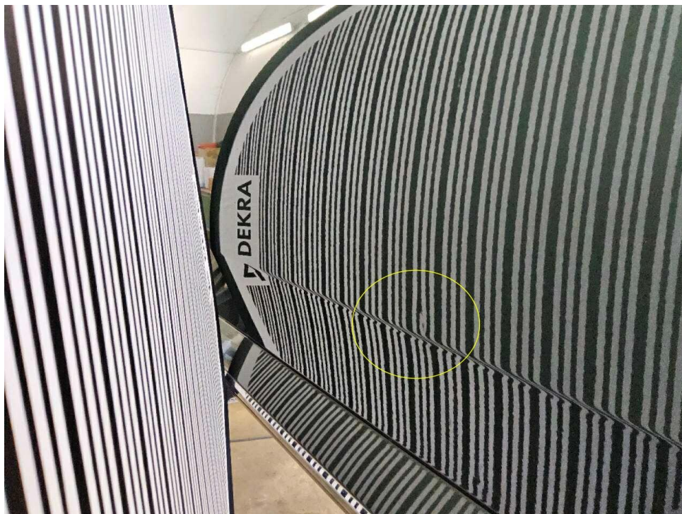
Bild 22 : Türe vorne links Delle
