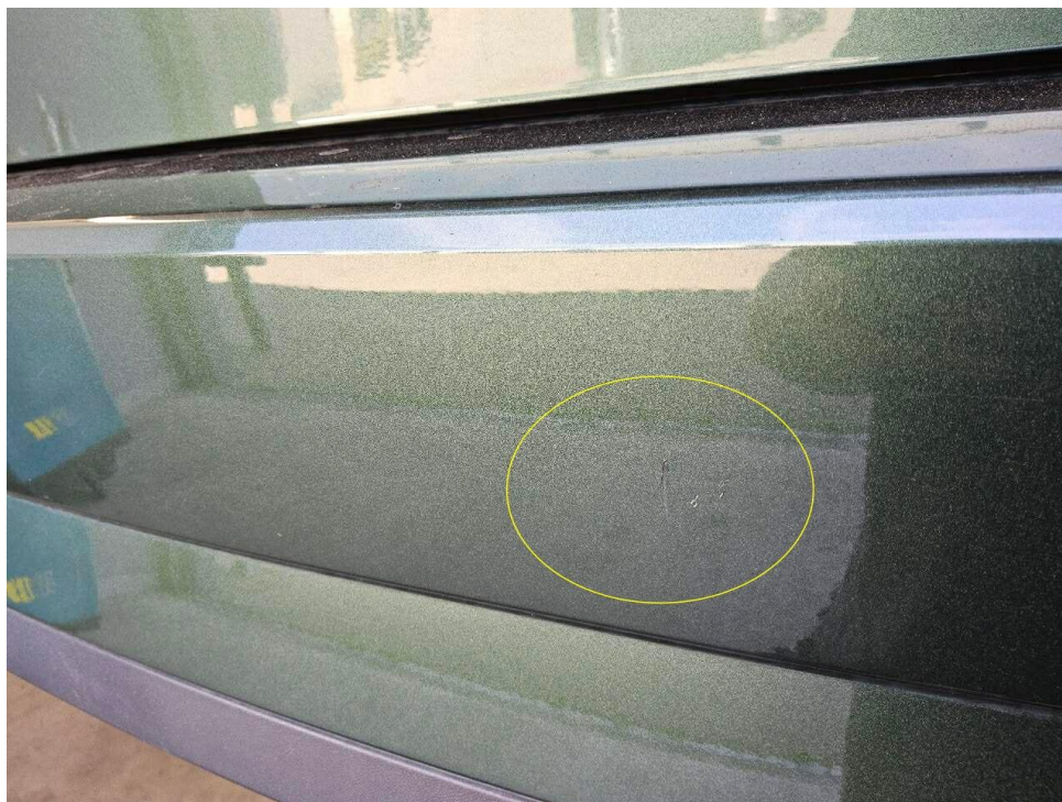
Bild 19 : Stoßfänger hinten mehrfach verkratzt
