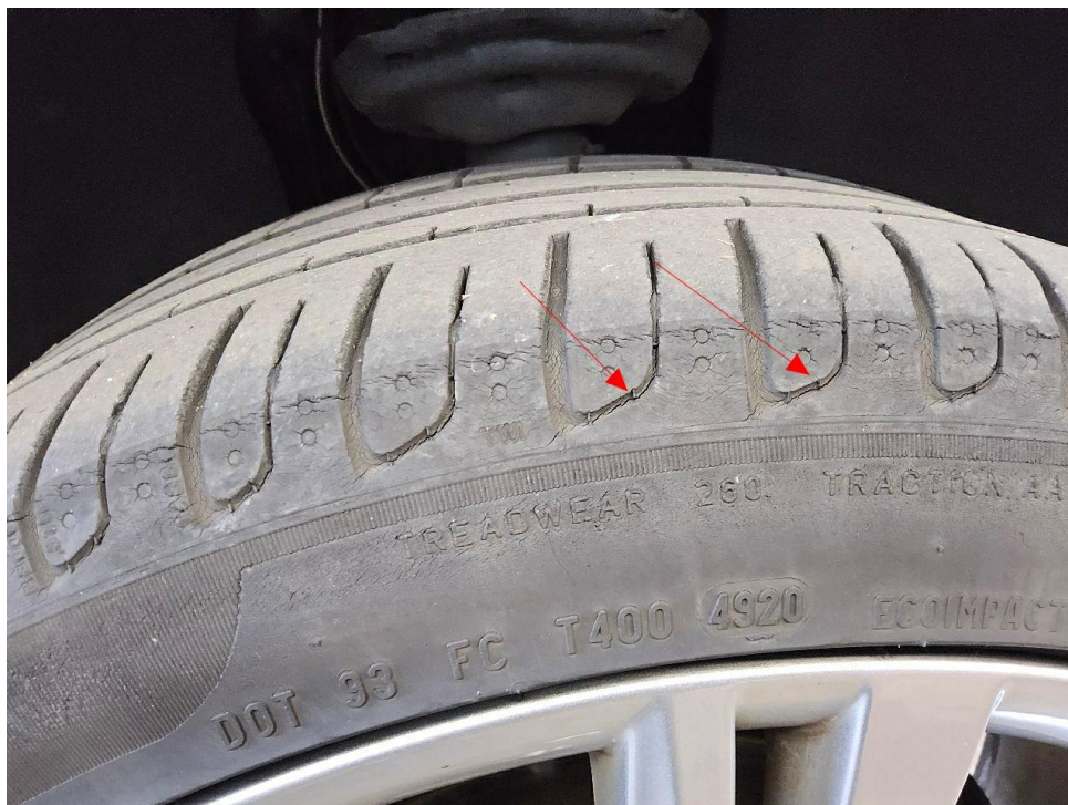
Bild 16 : Reifen Vorderachse porös und rissig
