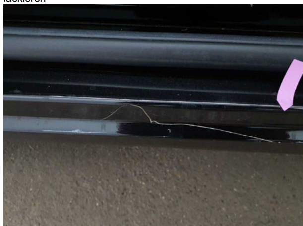
Beschädigung #12: Schweller rechts: Schweller - Delle / Lackschaden - instandsetzen und lackieren
