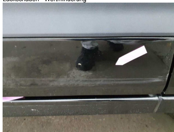
Beschädigung #10: Schiebetür rechts: Schiebetür - Kratzer - lackieren
