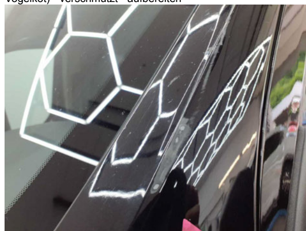
Beschädigung #2: Fahrzeugdach: Dachholm links - Kratzer - Smart Repair
