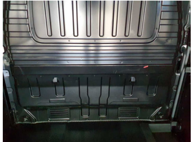
Beschädigung #9: Interieur: Laderaumunterteilung - Delle / Lackschaden - Wertminderung
