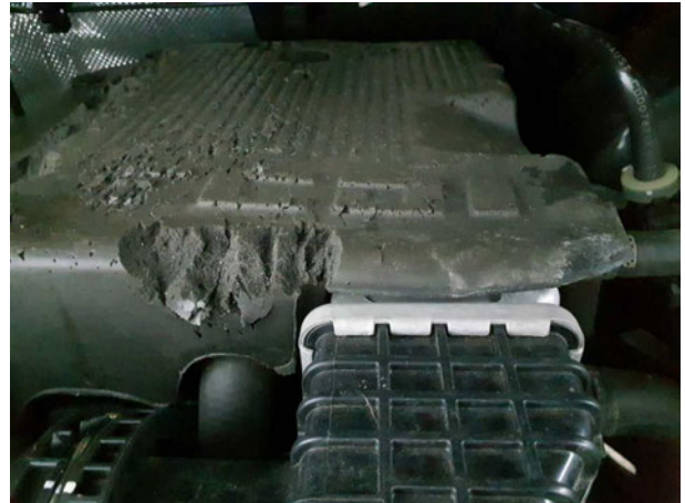
Beschädigung #6: Motor: Motorabdeckung - Marderschaden - erneuern
