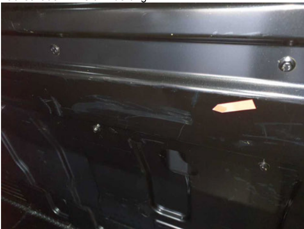
Beschädigung #9: Interieur: Laderaumunterteilung - Delle / Lackschaden - Wertminderung
