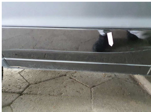
Beschädigung #11: Seitenwand rechts: Seitenwand - Kratzer - lackieren
