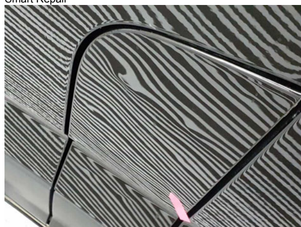
Beschädigung #3: Kraftstoffanlage: Tankdeckel - Delle(n) - Smart Repair
