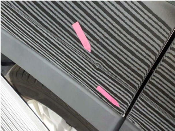
Beschädigung #8: Kotflügel links: Kotflügel links - Delle / Lackschad... - Smart Repair
