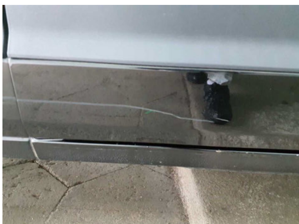
Beschädigung #10: Schiebetür rechts: Schiebetür - Kratzer - lackieren
