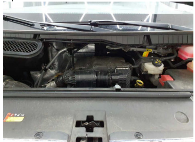
Beschädigung #6: Motor: Motorabdeckung - Marderschaden - erneuern
