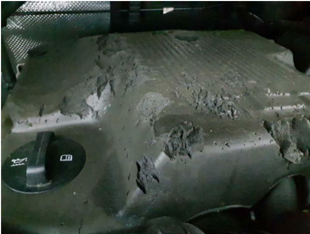
Beschädigung #6: Motor: Motorabdeckung - Marderschaden - erneuern
