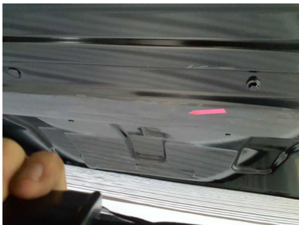
Beschädigung #9: Interieur: Laderaumunterteilung - Delle / Lackschaden - Wertminderung
