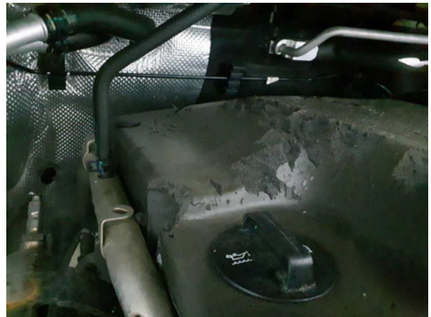
Beschädigung #6: Motor: Motorabdeckung - Marderschaden - erneuern
