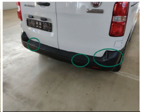
Stoßfänger / Hinten / Gebrochen
