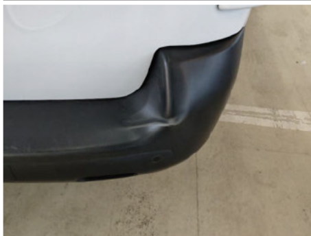
Stoßfänger / Hinten / Gebrochen
