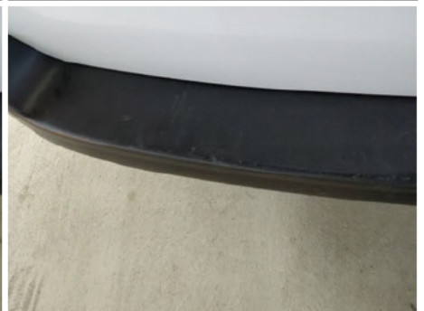
Stoßfänger / Hinten / Gebrochen
