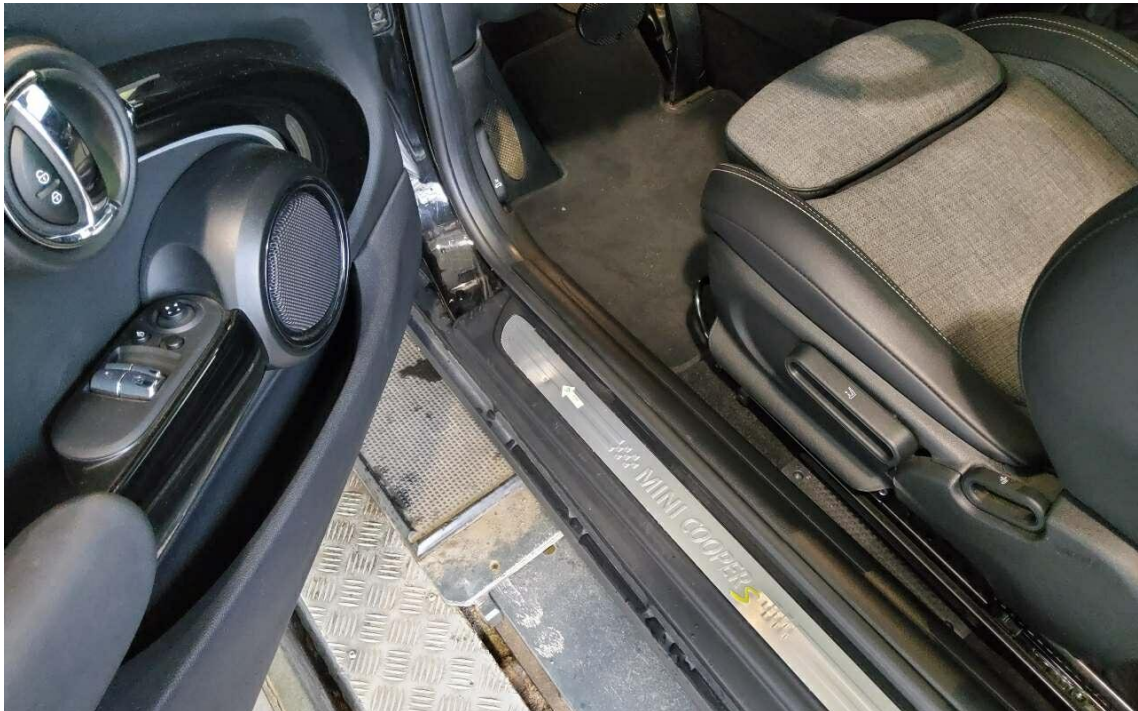
Bild 15 : Einstieg vorne links Zierblende eingedellt
