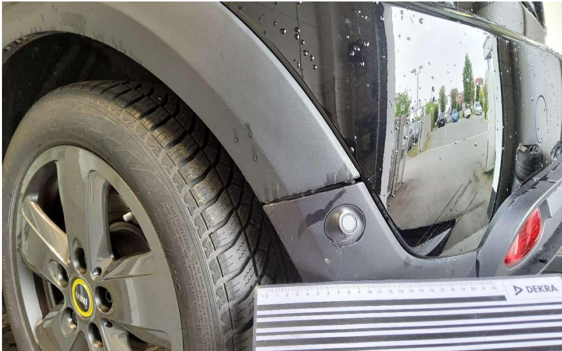
Bild 23 : Stoßfänger hinten Spoiler zerkratzt
