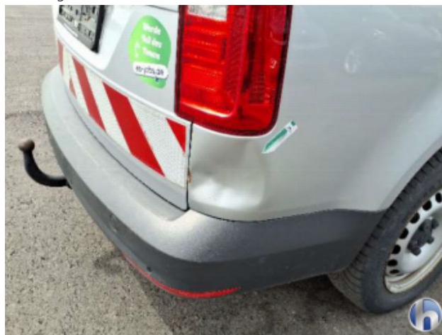
1. Seitenwand - Hinten - Rechts Beschädigt - Siehe Kalkulation
