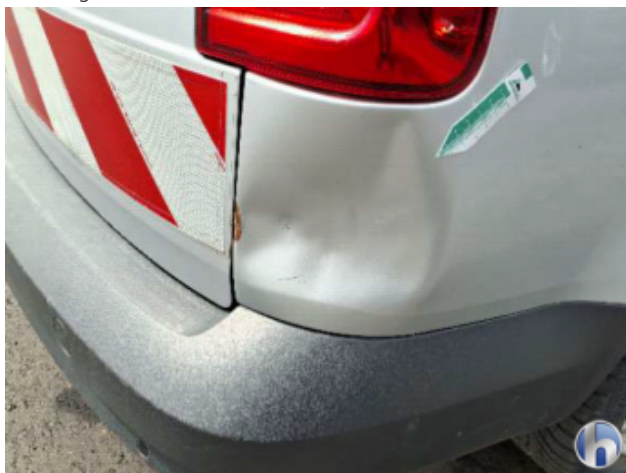
1. Seitenwand - Hinten - Rechts Beschädigt - Siehe Kalkulation
