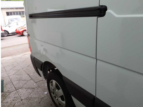
Beschädigung #1: Seitenwand rechts: Seitenwand (Reste) - beklebt/ beschriftet - entkleben/neutralisieren
