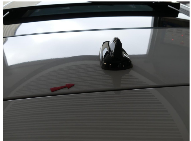
Dach - Delle - kein Abzug
