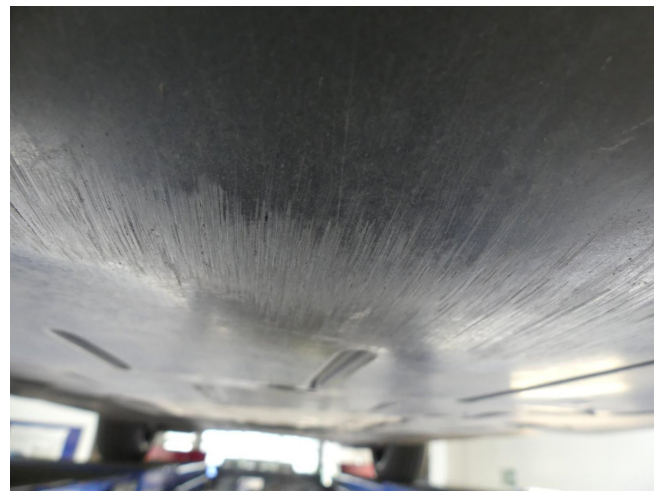
Unterboden - Kratzer - Gebrauchsspur
