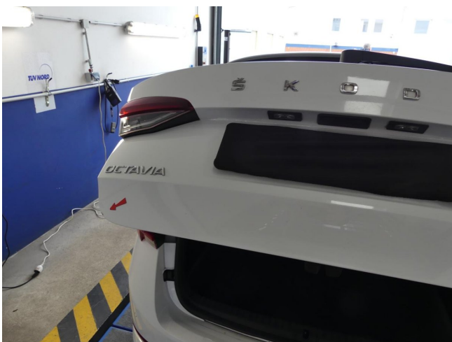
Heckklappe - Rost - entfernen und lackieren
