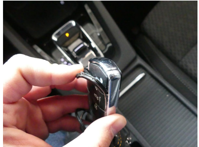
Fahrzeugschlüssel - beschädigt - erneuern
