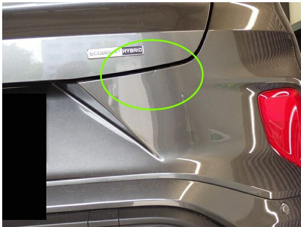
Bild 20 : Stoßfänger hinten oben verformt
