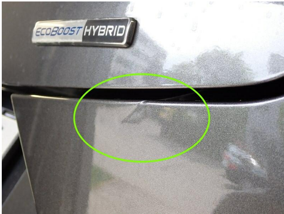
Bild 22 : Stoßfänger hinten oben verformt
