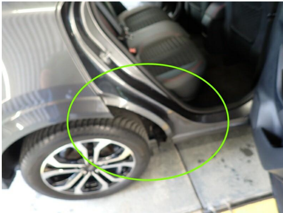
Bild 15 : Dichtungsgummi Einstieg HR fehlt
