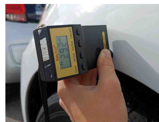
Lackstärke Kotflügel vorne links
