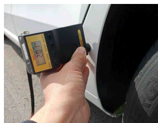
Lackstärke Seitenwand hinten links
