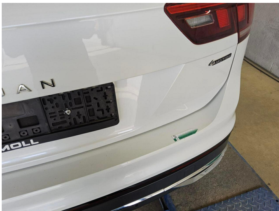
Bild 16 : Stoßfänger hinten Lackierung, zerkratzt, Gebrauchsspur
