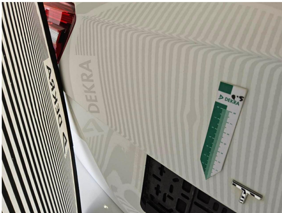
Bild 15 : Heckklappe, eingedellt, Gebrauchsspur
