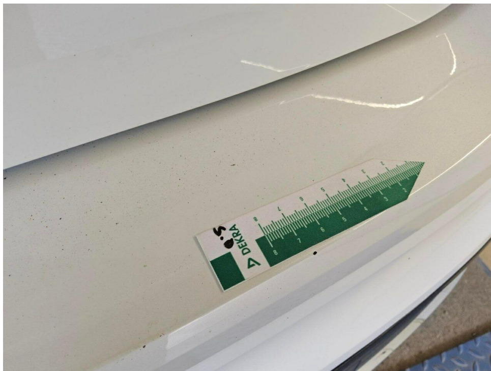
Bild 17 : Stoßfänger hinten Lackierung, zerkratzt, Gebrauchsspur
