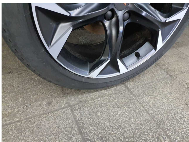
Beschädigung #3: Rad/Reifen: Leichtmetallfelge hinten rechts - Kratzer - Wertminderung
