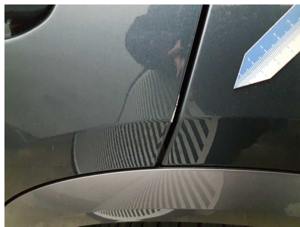
Beschädigung #2: Tür hinten links: Türkante - Kratzer - Smart Repair
