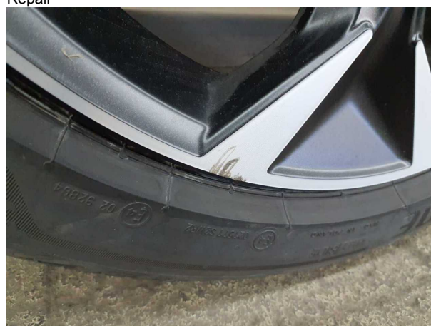
Beschädigung #3: Rad/Reifen: Leichtmetallfelge hinten rechts - Kratzer - Wertminderung
