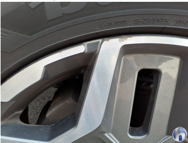
6. Felge Vorne - Links Kratzer - Smart Repair 100,00 € / 100,00 €
