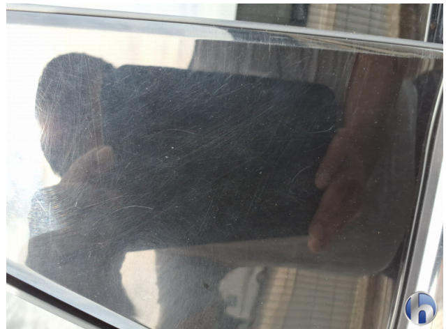
12. C-Säule Hinten - Rechts Kratzer - Erneuern 111,00 € / 111,00 €
