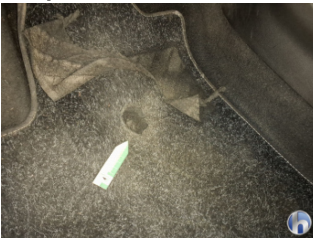
2. Fußraum Innenraum links vorne Loch - Erneuern
