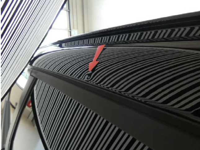
Dach - Delle - entfernen
