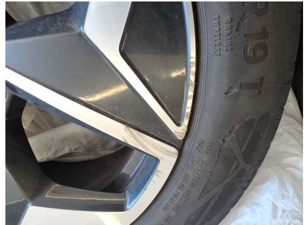
Beschädigung #9: 2.Radsatz: 3 Leichtmetallfelgen - verkratzt / verschürft - Wertminderung
