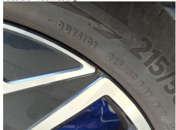
Beschädigung #9: 2.Radsatz: 3 Leichtmetallfelgen - verkratzt / verschürft - Wertminderung
