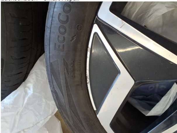
Beschädigung #9: 2.Radsatz: 3 Leichtmetallfelgen - verkratzt / verschürft - Wertminderung
