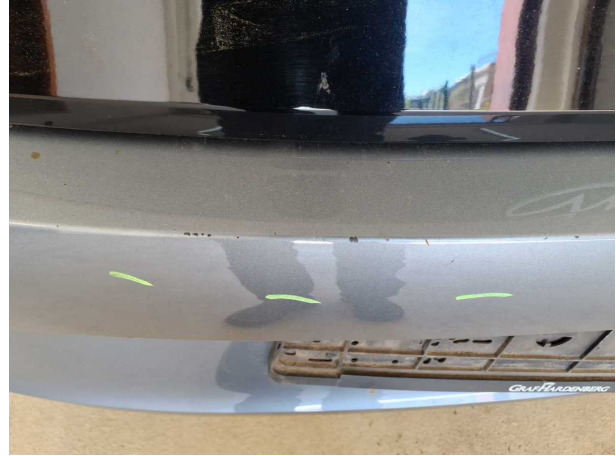
Beschädigung #10: Stossfänger hinten: Stossfänger hinten - verkratzt / verschürft - instandsetzen und lackieren
