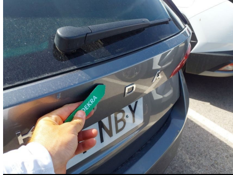
Portón trasero / puerta del maletero / - / Abolladura
