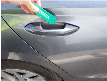
Manetas de puerta / Trasero Derecho / Ralladura
