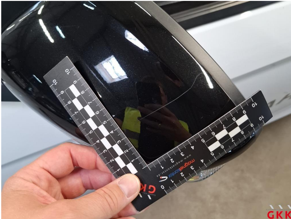
Bild 15 Spiegelgehäuse links, Kappe -lackiert-, verkratzt, lackieren ohne LV
