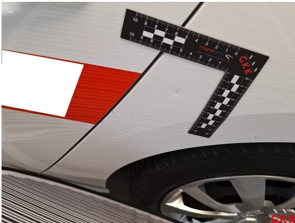
Bild 24 Seitenwand links, beschädigt, instand setzen - lackieren
