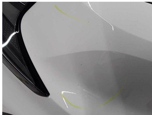
Beschädigung #2: Stossfänger vorn: Stossfänger vorn - Steinschlag - auslegen / polieren
