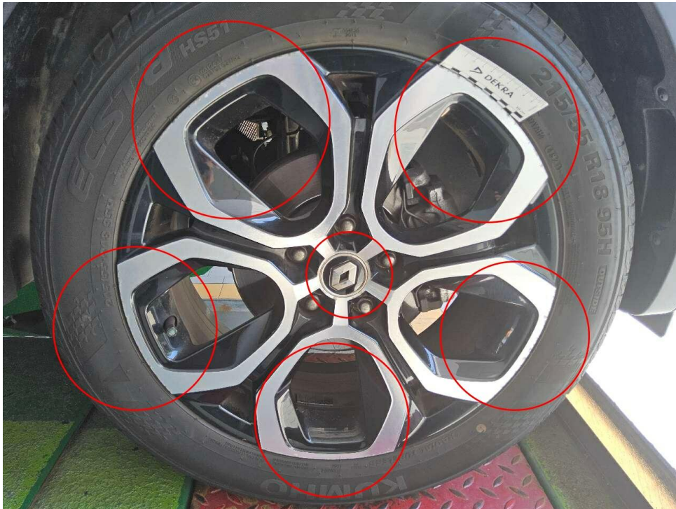
Bild 15 : Felge vorne rechts Lackierung, zerkratzt, Gebrauchsspur
