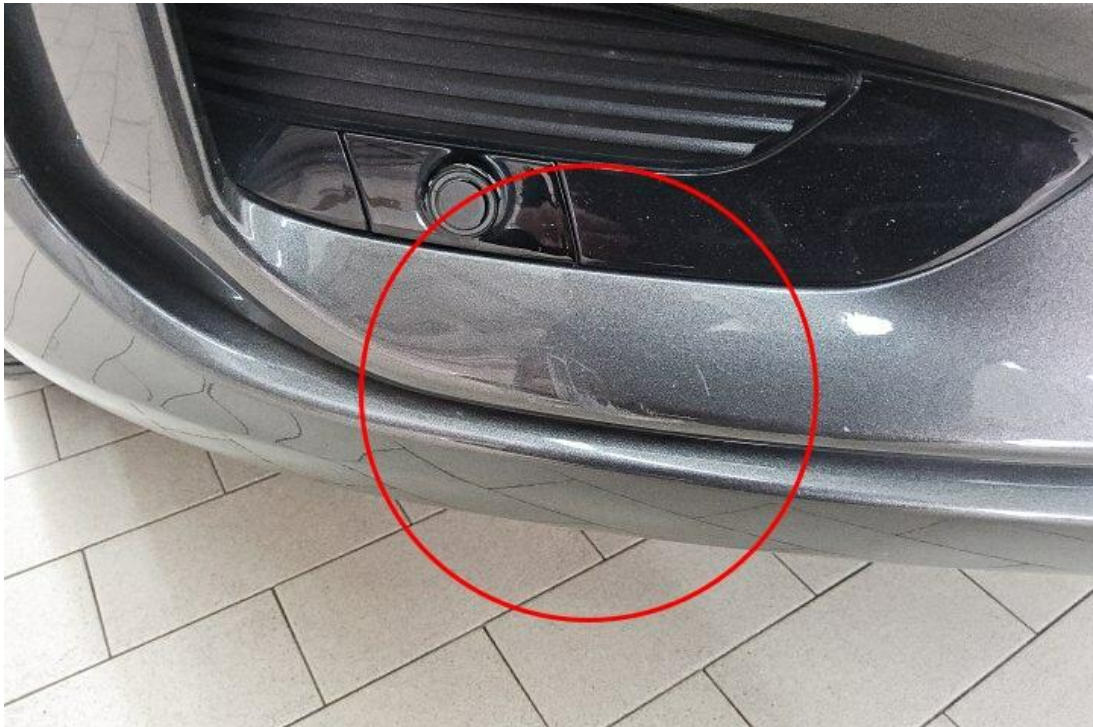
Bild 15 : Stoßfänger vorne, verschrammt, polieren
