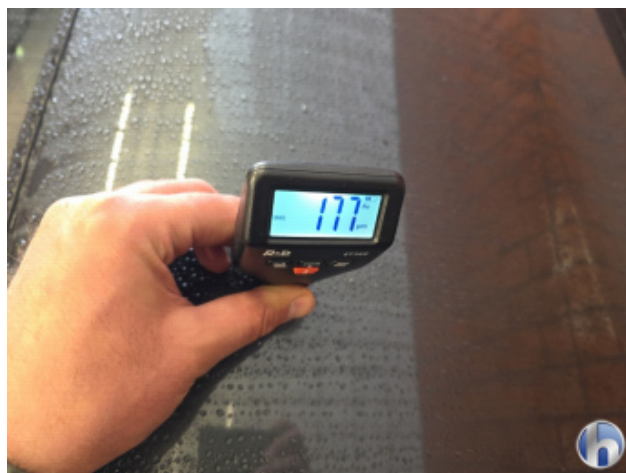
1. Tür Hinten - Links Nachlackiert - Ohne Reparatur
