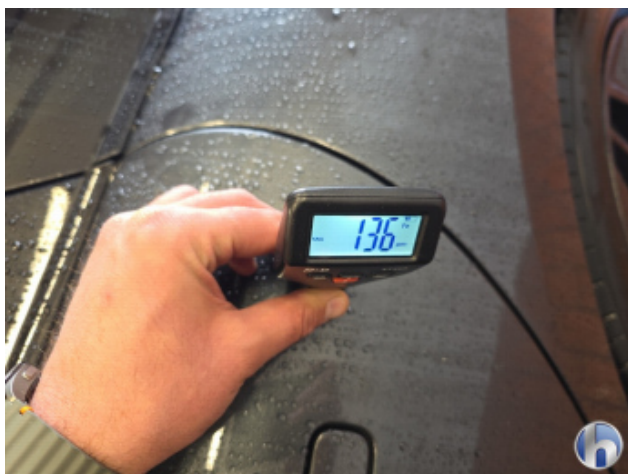
1. Tür Hinten - Links Nachlackiert - Ohne Reparatur
