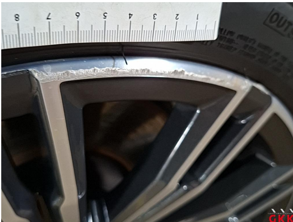
Bild 20 LM-Rad, vorne rechts, Materialabtrag, ersetzen
