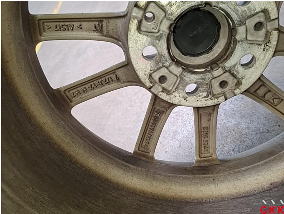
Bild 33 LM-Rad, 1 x beiliegend, Materialabtrag, ersetzen
