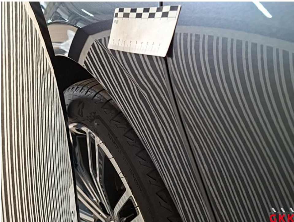
Bild 38 Seitenwand rechts, beschädigt, instand setzen - lackieren
