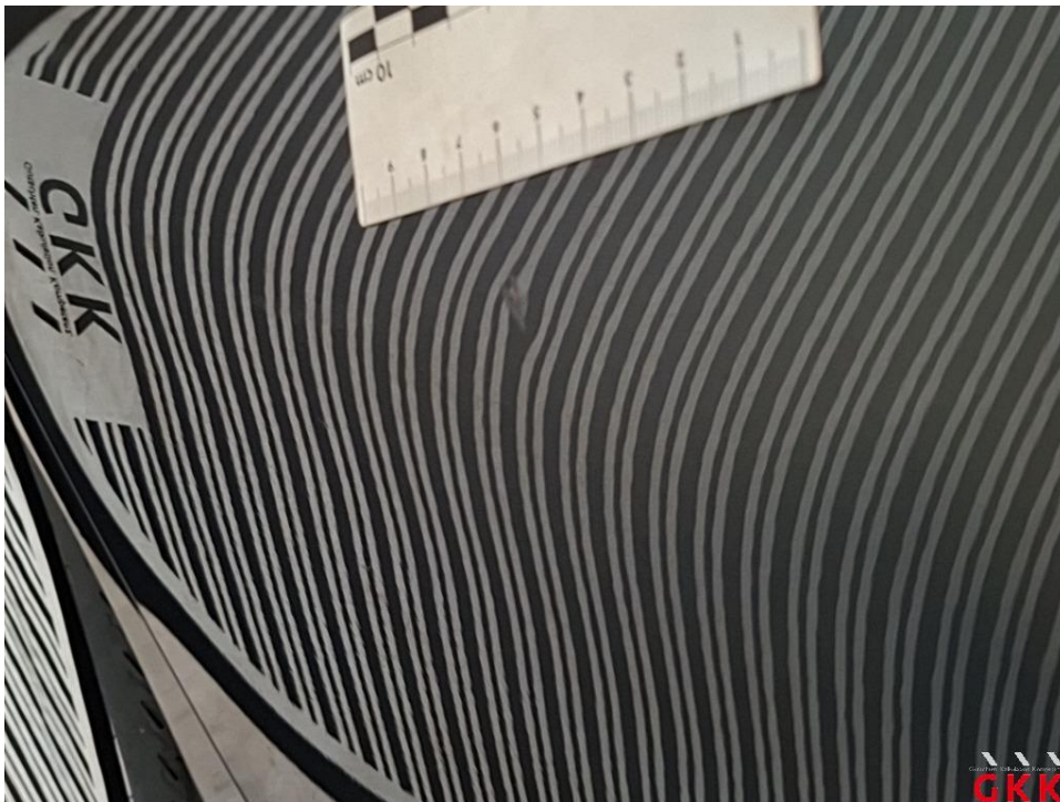
Bild 40 Tür hinten rechts, beschädigt, instand setzen - lackieren
