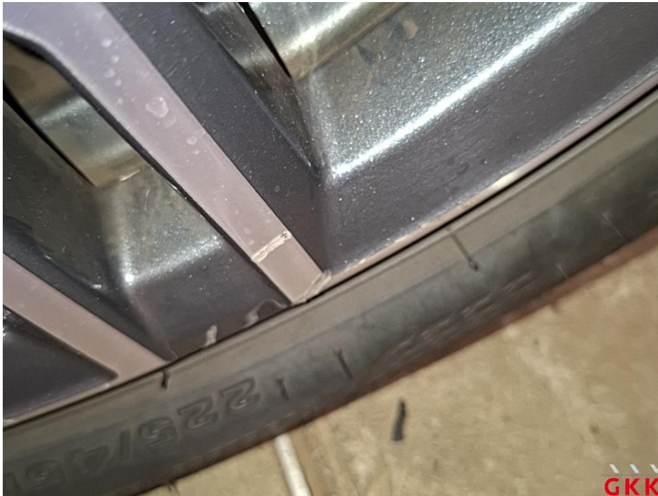
Bild 27 LM-Rad, vorne links, Materialabtrag, ersetzen
