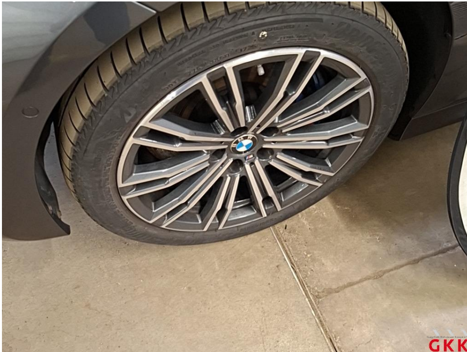
Bild 25 LM-Rad, vorne links, Materialabtrag, ersetzen
