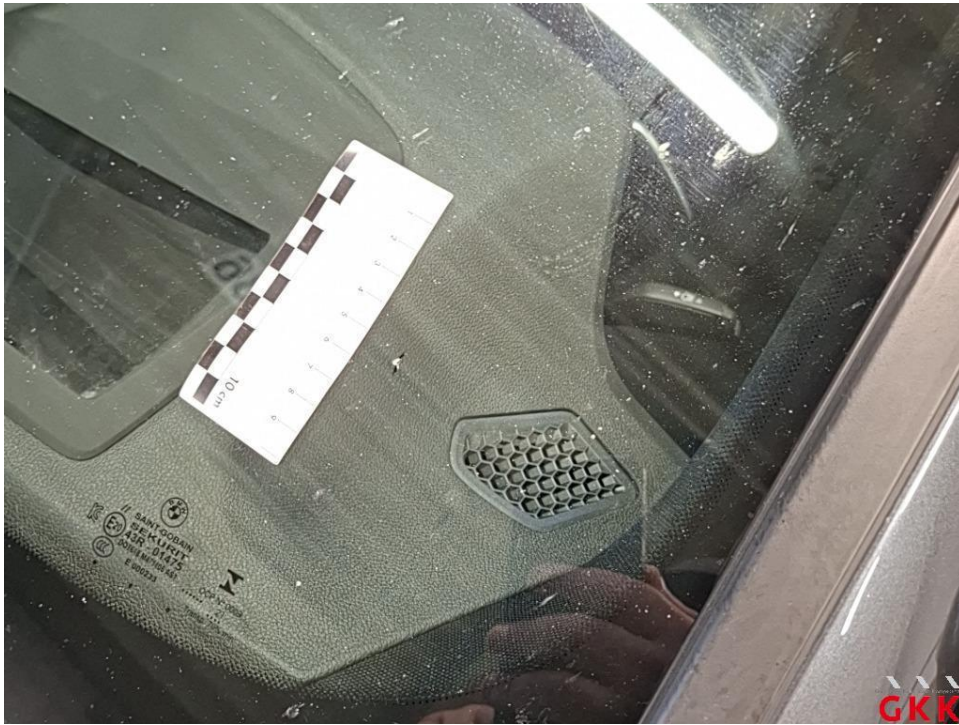
Bild 17 Frontscheibe, mit Regensensor und Frontkamera, Steinschlag mit Rissbildung, ersetzen
