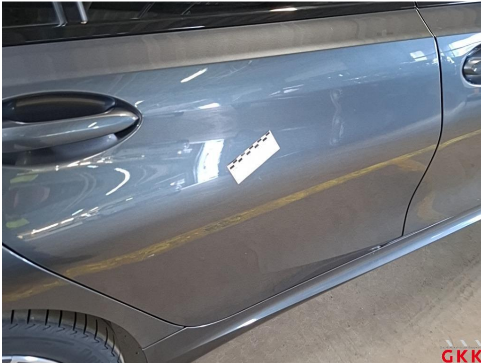
Bild 39 Tür hinten rechts, beschädigt, instand setzen - lackieren
