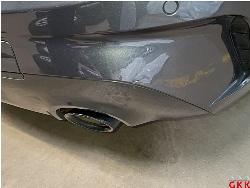
Bild 34 Stoßfänger hinten, Verkleidung -lackiert-, beschädigt, instand setzen - lackieren
