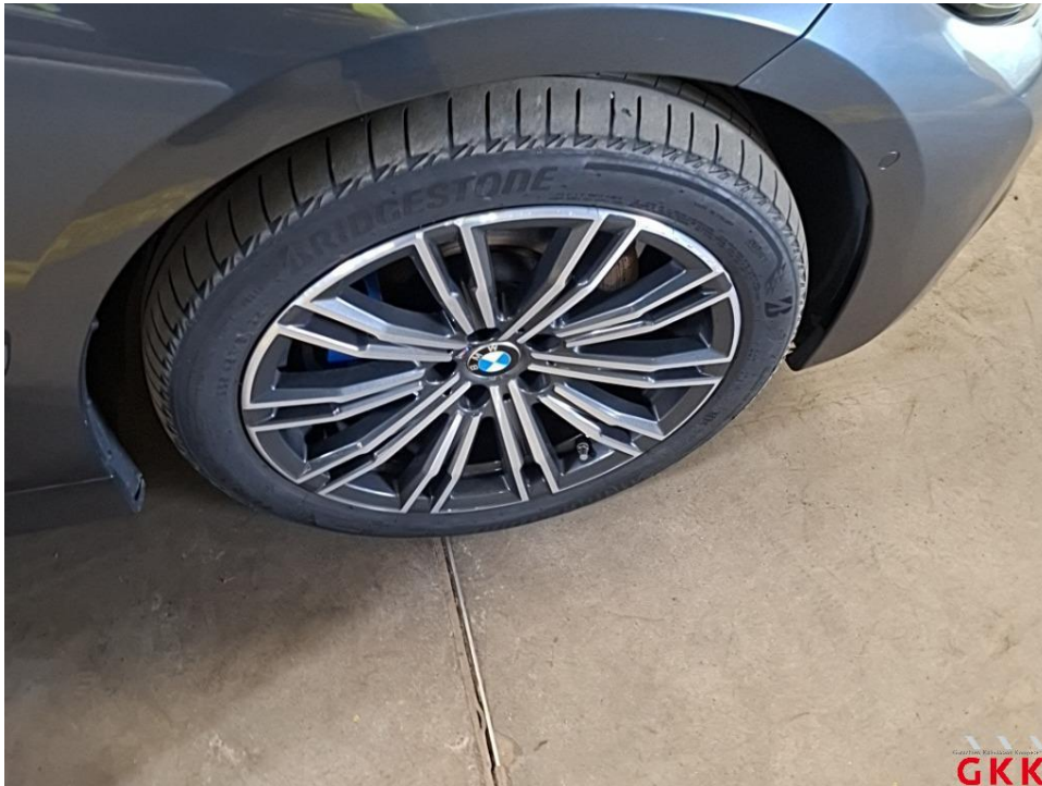
Bild 19 LM-Rad, vorne rechts, Materialabtrag, ersetzen
