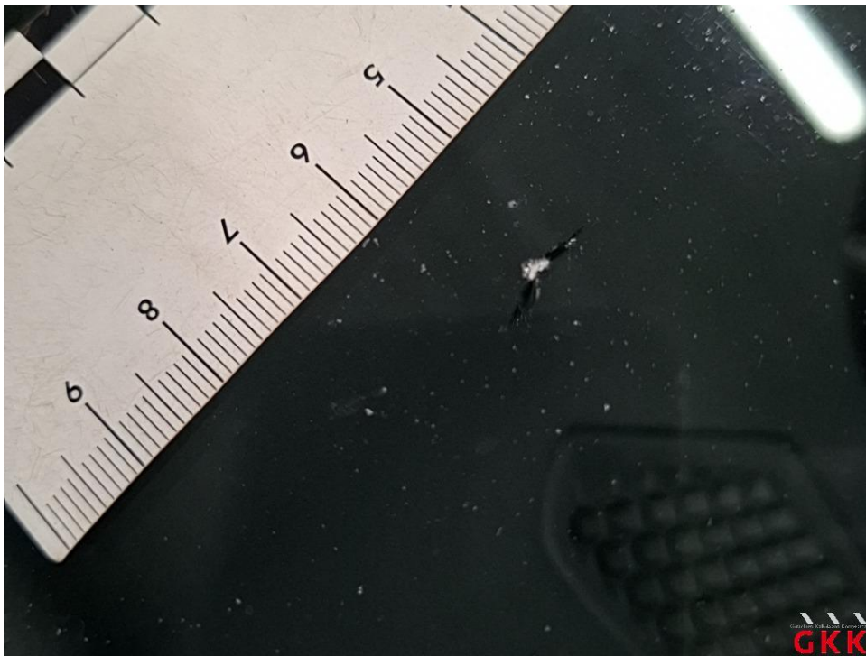
Bild 18 Frontscheibe, mit Regensensor und Frontkamera, Steinschlag mit Rissbildung, ersetzen
