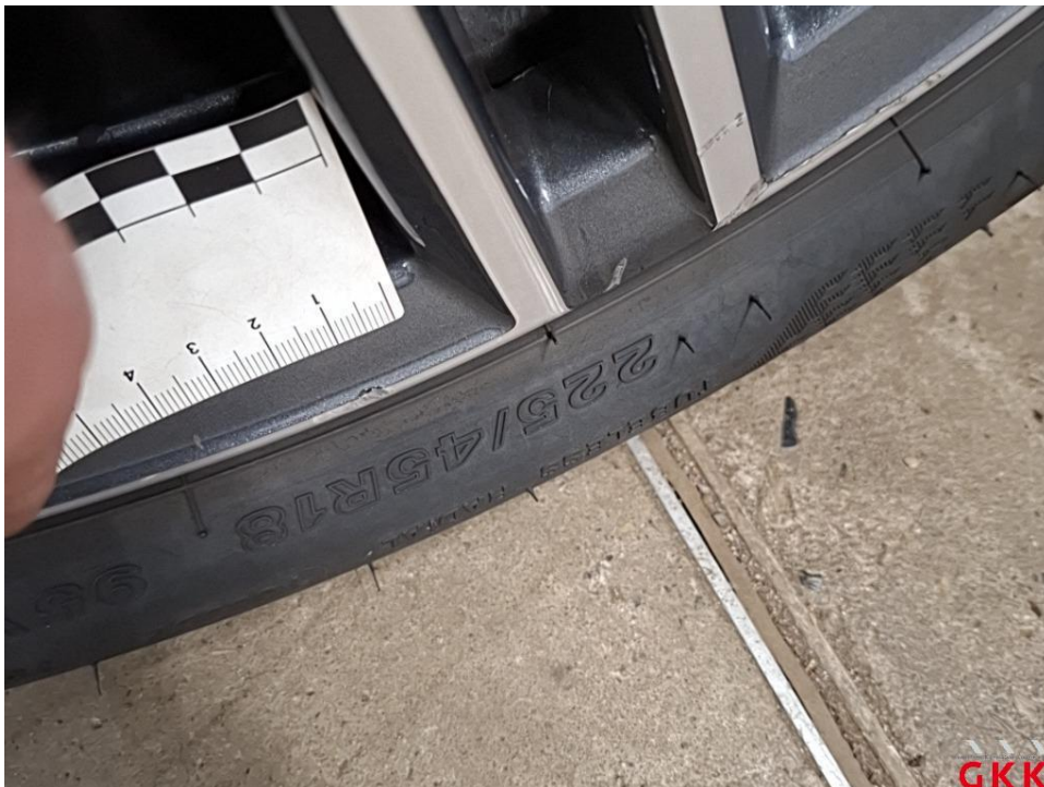
Bild 26 LM-Rad, vorne links, Materialabtrag, ersetzen
