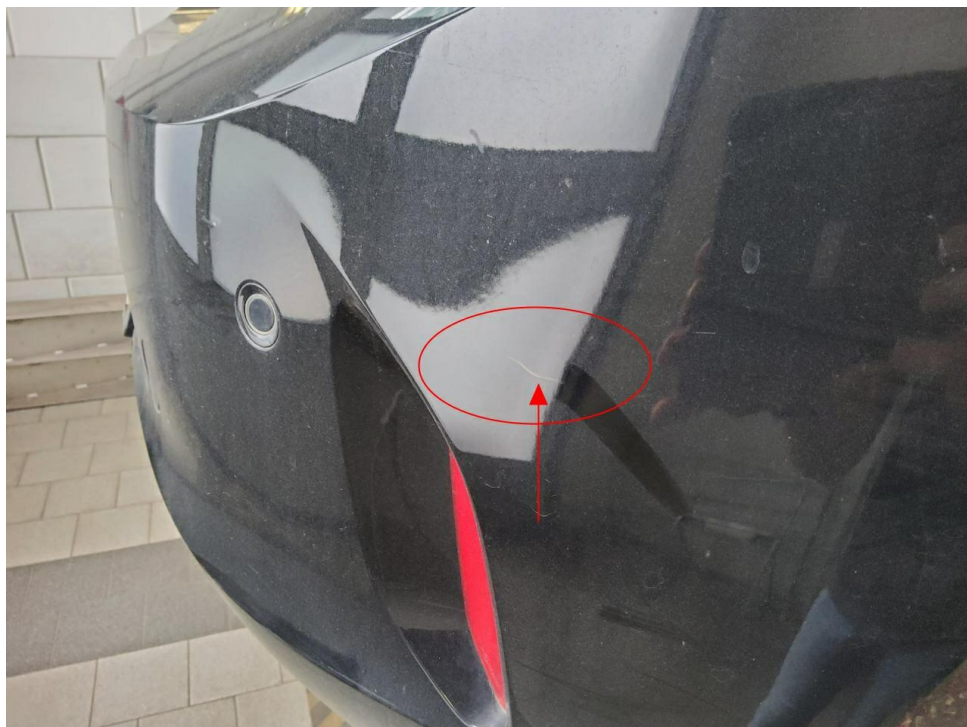
Bild 16 : Stoßfänger hinten Lackierung, zerkratzt, lackieren mit Lackaufbau
