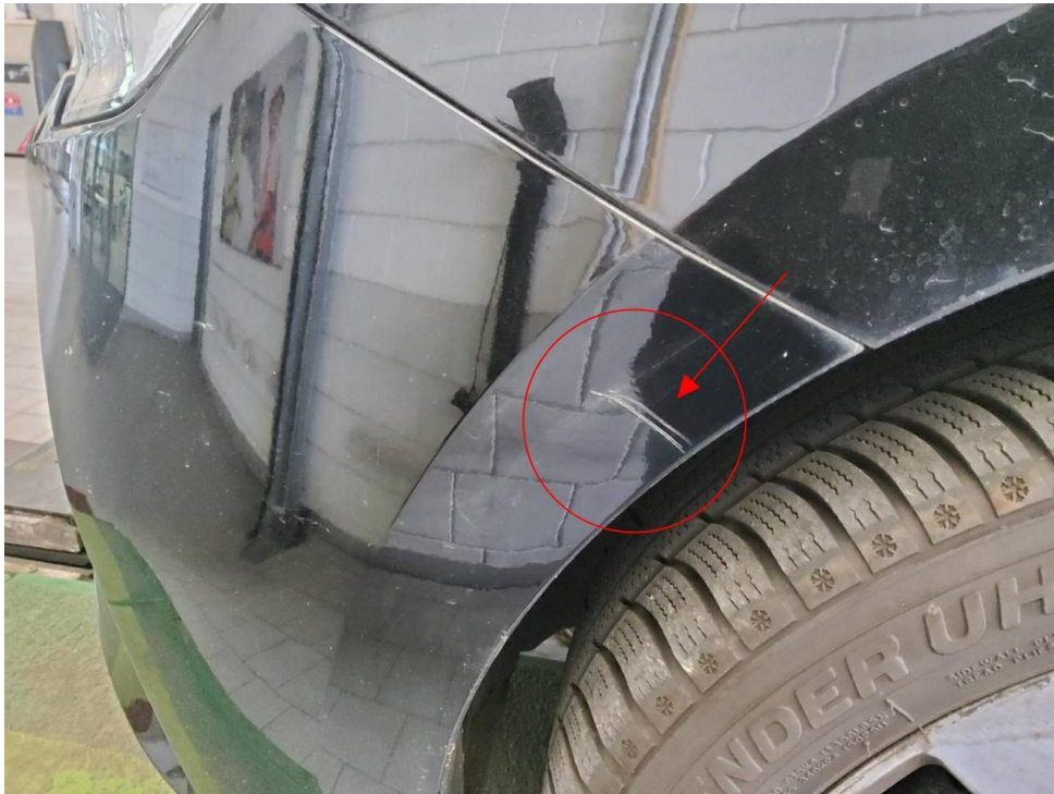
Bild 13 : Stoßfänger vorne Lackierung, zerkratzt, smart repair
