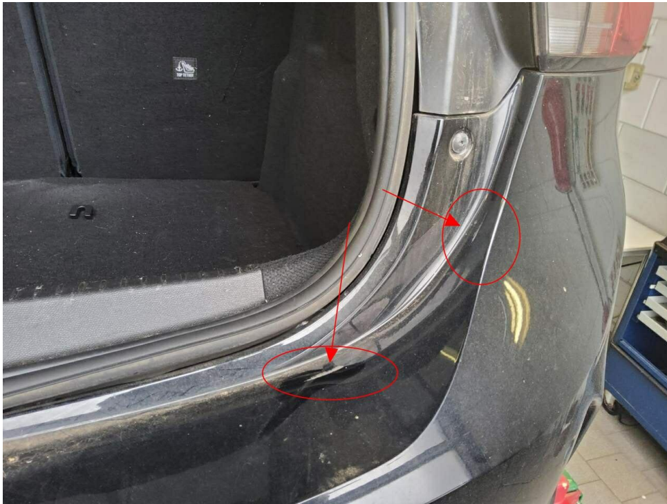
Bild 17 : Stoßfänger hinten Lackierung, zerkratzt, lackieren mit Lackaufbau
