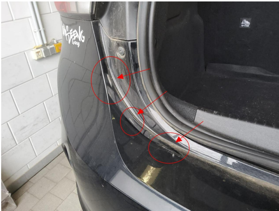
Bild 18 : Stoßfänger hinten Lackierung, zerkratzt, lackieren mit Lackaufbau
