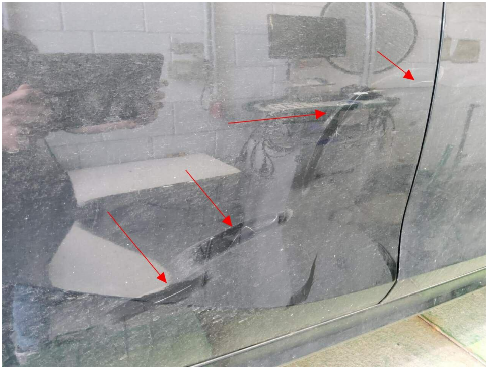
Bild 19 : Tür hinten rechts Lackierung, zerkratzt, lackieren mit Lackaufbau
