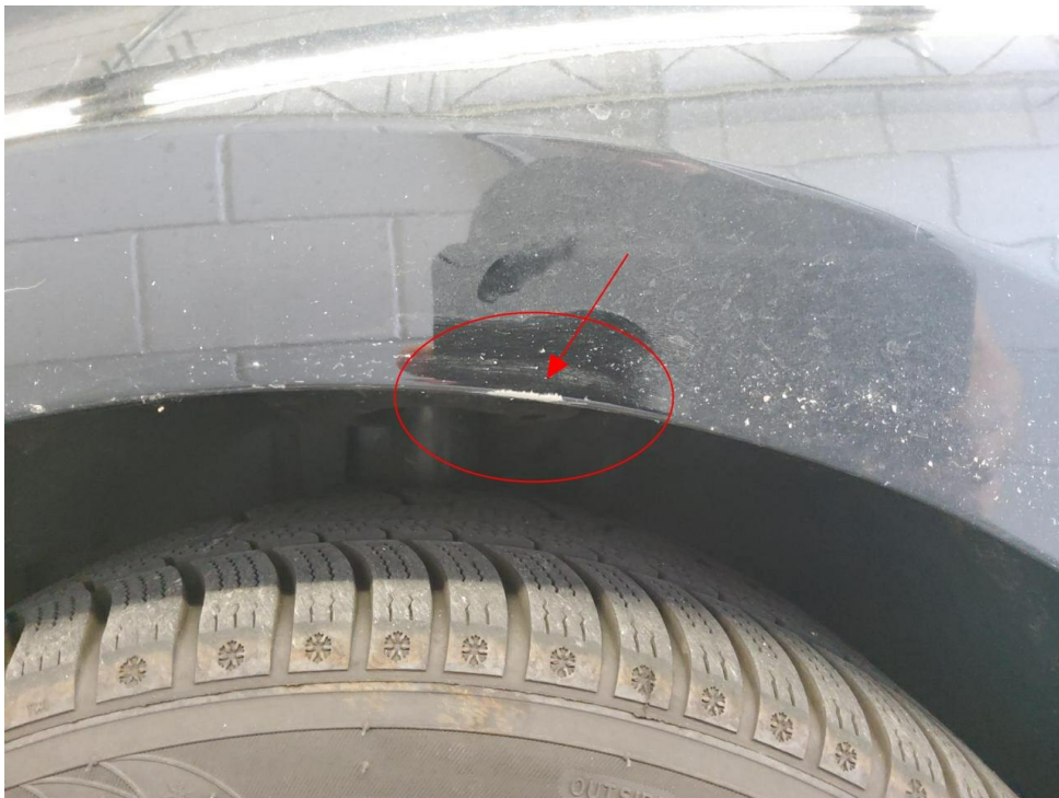
Bild 14 : Kotflügel vorne links Lackierung, zerkratzt, smart repair
