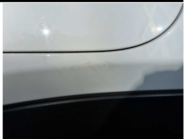
Beschädigung #4: Seitenwand rechts: Seitenwand - Kratzer - Smart Repair
