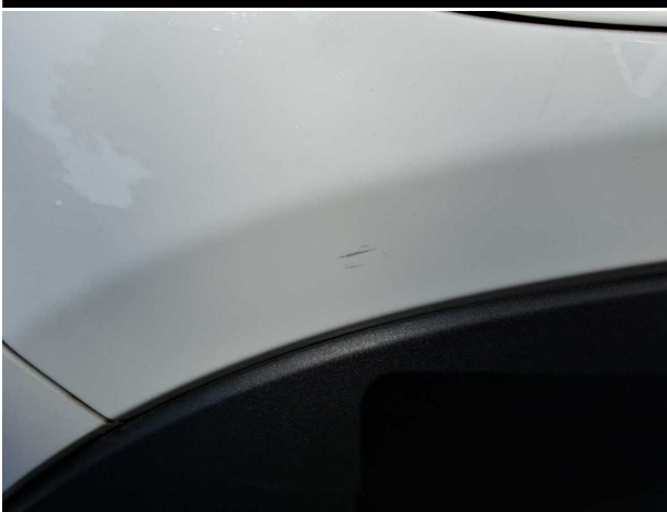
Beschädigung #4: Seitenwand rechts: Seitenwand - Kratzer - Smart Repair
