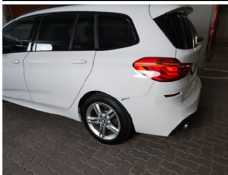
Stoßfänger / Hinten / Abgewetzt
