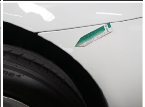
Stoßfänger / Hinten / Abgewetzt
