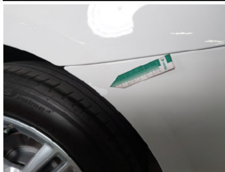
Stoßfänger / Hinten / Abgewetzt
