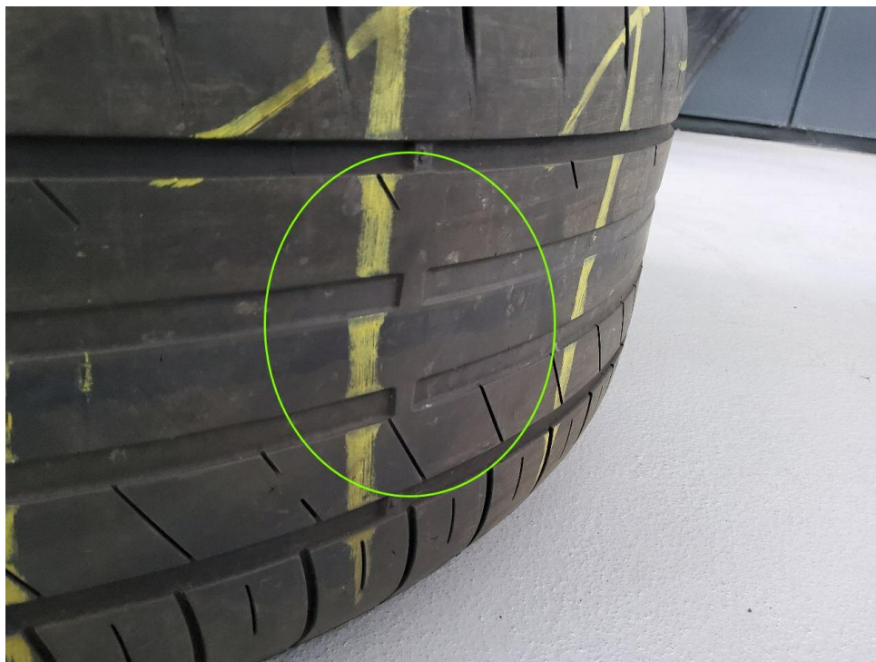
Bild 35 : Achse 1, Reifen 2 Links 1 <2mm Restprofil
