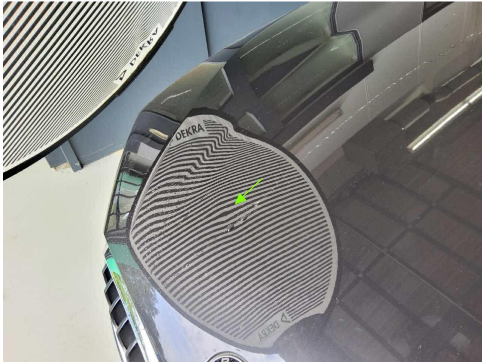
Bild 23 : Motorhaube, eingedellt, Gebrauchsspur
