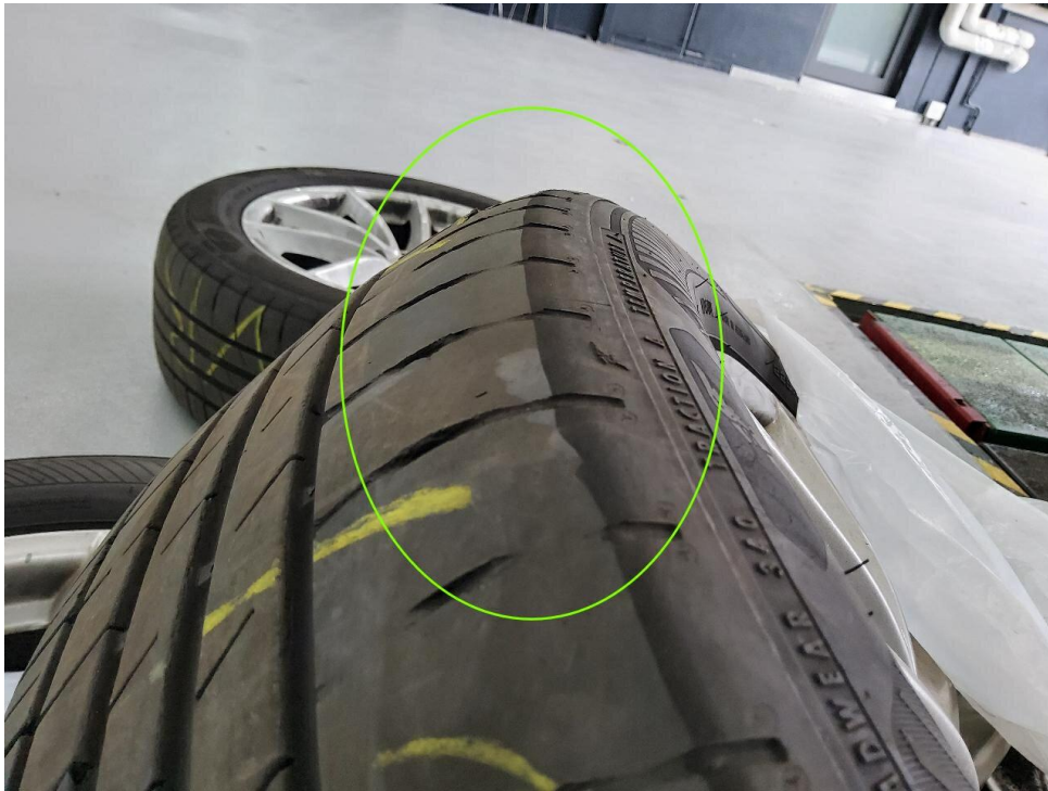
Bild 37 : Achse 2, Reifen 2 Links 1 Außenschultern verschlissen
