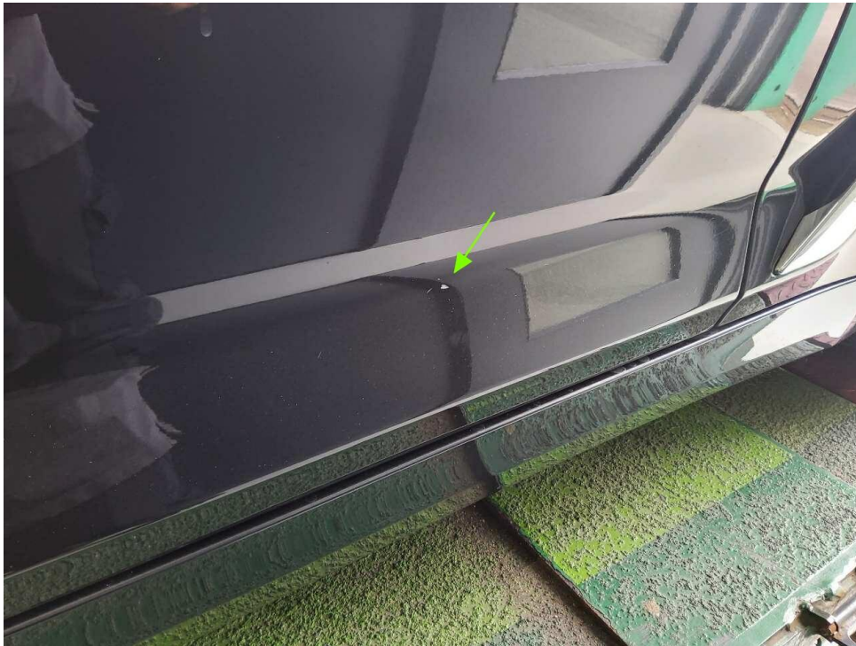
Bild 33 : Tür VR Steinschlag
