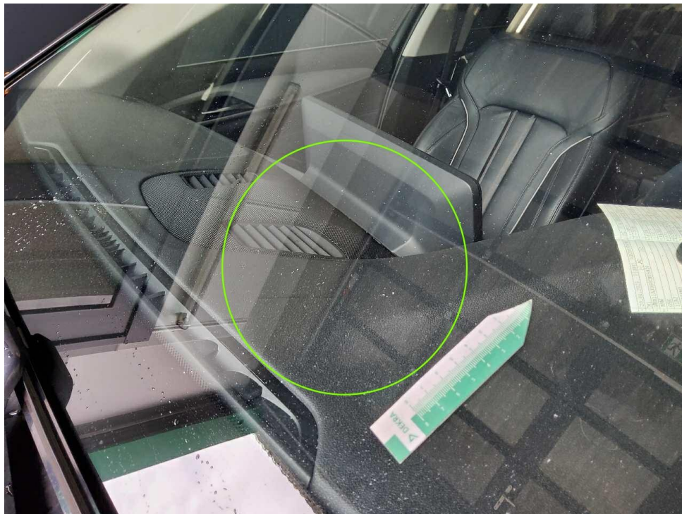
Bild 30 : Frontscheibe übermäßige Steinschläge/ Absplitterung/ Kratzer
