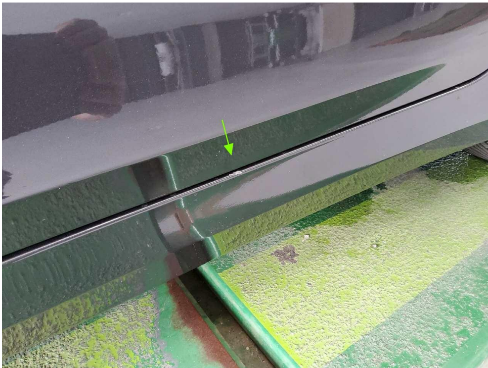
Bild 34 : Schwellerblende links zerkratzt auslegen
