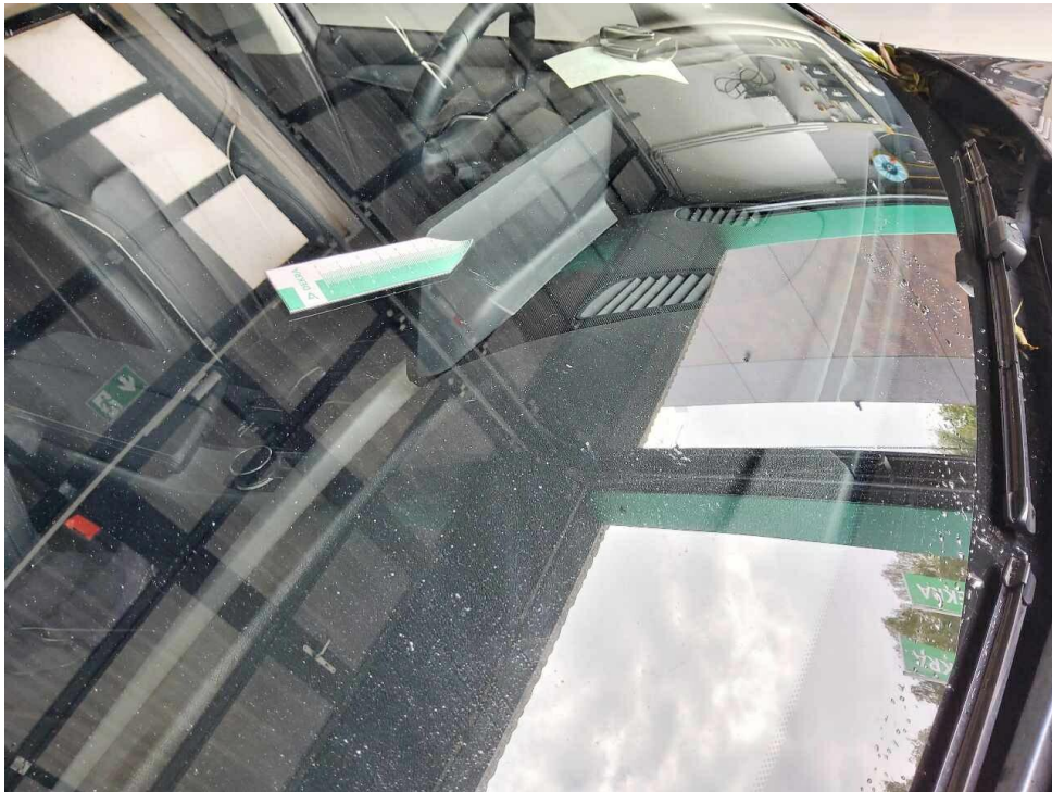
Bild 31 : Frontscheibe übermäßige Steinschläge/ Absplitterung/ Kratzer
