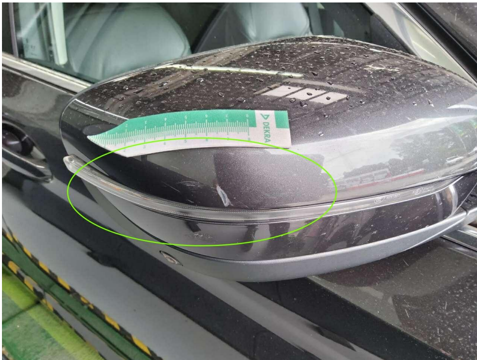
Bild 14 : Außenspiegel rechts Lackierung, verschrammt, smart repair
