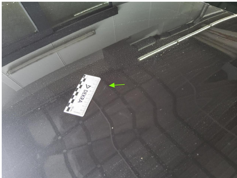
Bild 25 : Motorhaube Lackierung, zerkratzt, polieren
