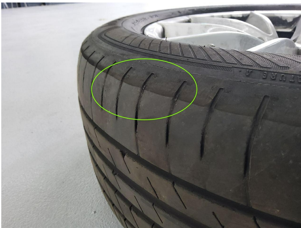
Bild 38 : Achse 2, Reifen 2 Rechts 1 Außenschultern verschlissen
