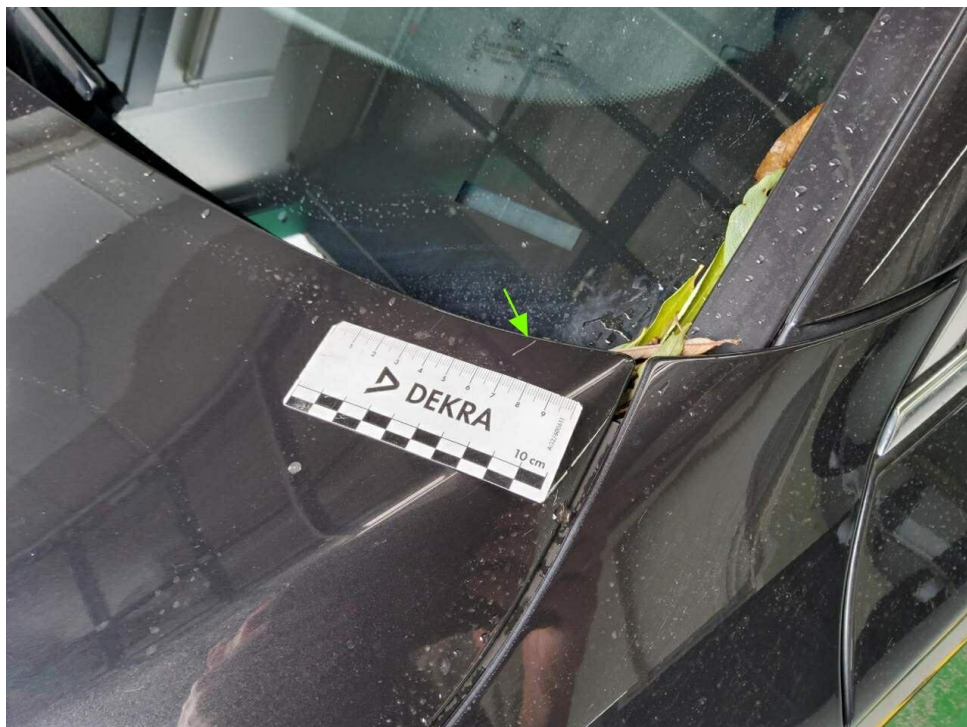
Bild 24 : Motorhaube Lackierung, zerkratzt, polieren
