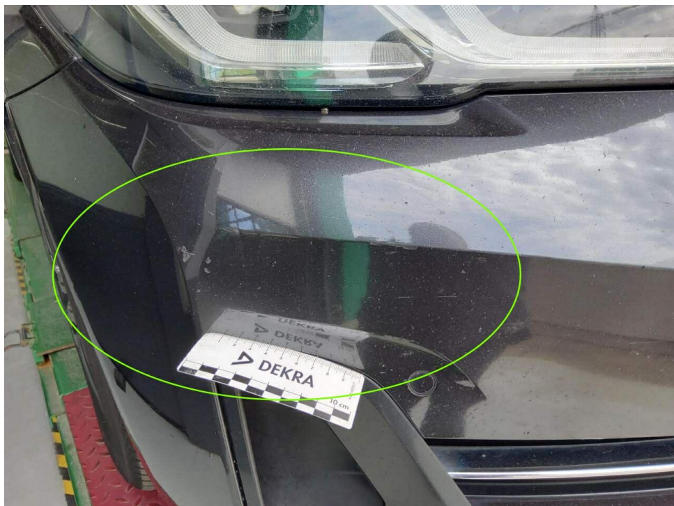
Bild 18 : Stoßfänger vorne Lackierung, verschrammt, lackieren mit Lackaufbau
