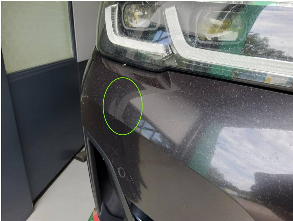
Bild 15 : Stoßfänger vorne, eingedellt, Gebrauchsspur
