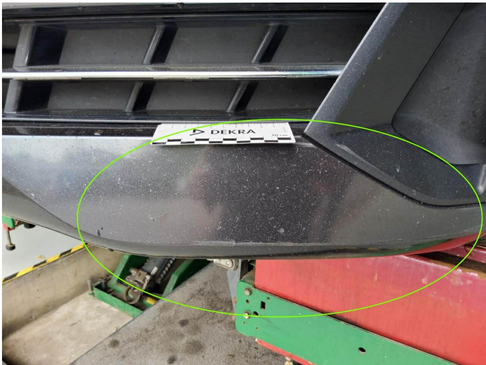
Bild 16 : Stoßfänger vorne Lackierung, verschrämmt, lackieren mit Lackaufbau
