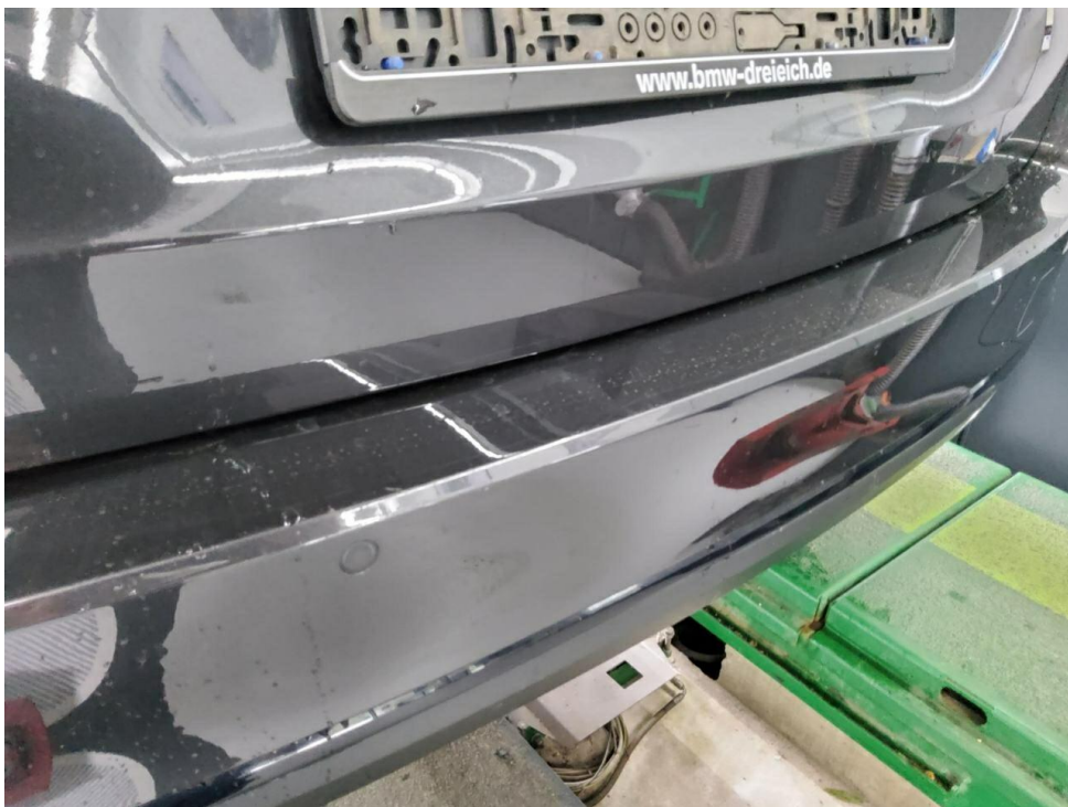
Bild 20 : Stoßfänger hinten Lackierung, zerkratzt, polieren
