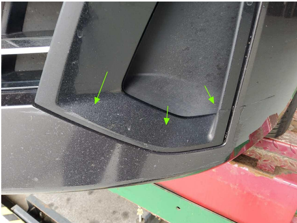
Bild 32 : Blende Stoßfänger VL verschrammt (Verbundarbeit)
