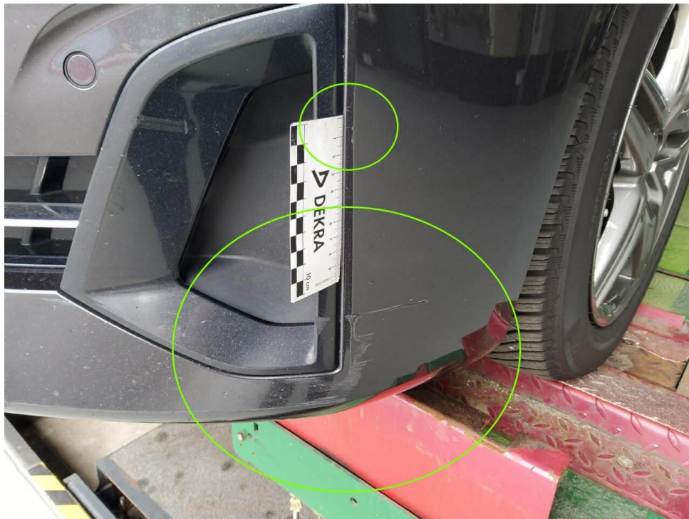
Bild 17 : Stoßfänger vorne Lackierung, verschrammt, lackieren mit Lackaufbau
